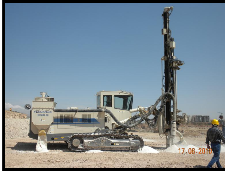
Şekil 7.9. Furukawa HCR 12 marka delik delme makinesi
