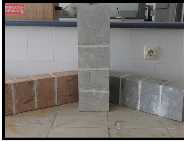
3.13b. Yapay titreşim kaynağının oluşturulduğu noktaya dik olarak oluşturulan süreksizliklerin fotoğraf görünüşü
