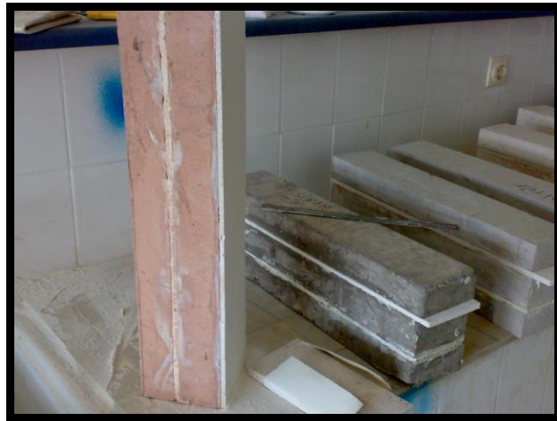
Şekil 3.11. Titreşim deney numunelerinin hazırlanması ve kullanılan dolgu maddesi
