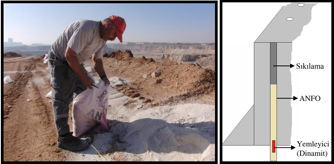
Şekil 7.11. Deliklere patlayıcı madde şarjı
