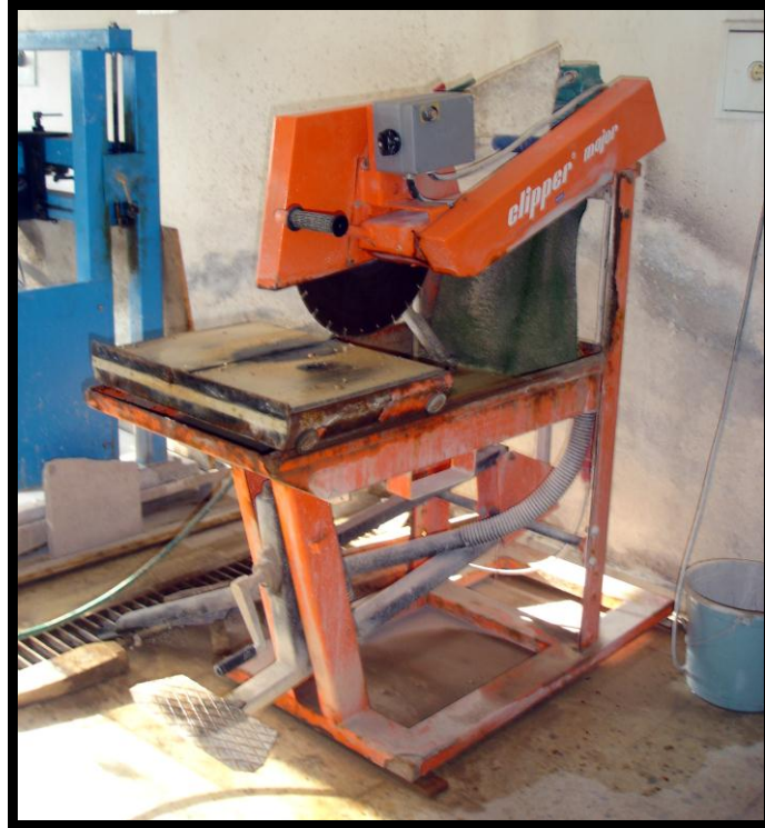
Şekil 3.2. Blok kesme-düzeltilme makinesi
