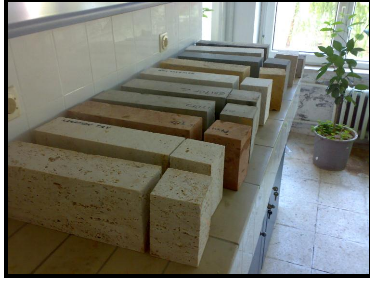
Şekil 3.10. Yapay süreksizlik düzlemi oluşturulmak üzere ana kayaktan kesilen parçalar
