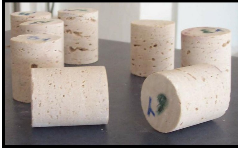
Őekil 3.8. Nokta ykleme deneyi iin hazırlanan Traverten- KRM numuneleri
