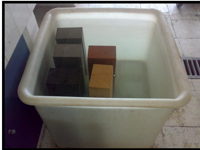
Şekil 5.4. Numunelerin suya doygun hale getirilişi
