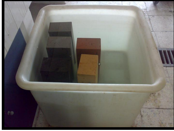
Şekil 3.17. Numunelerin su dolu kaptaki suya doymuş hale getirilmesi
