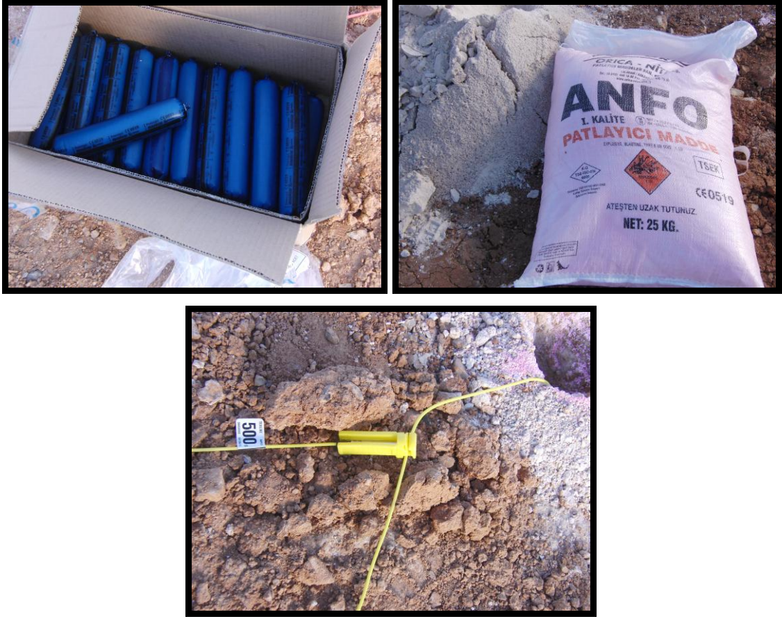
Şekil 7.13. ANFO, emülsiyon dinamit ve gecikmeli kapsüller
