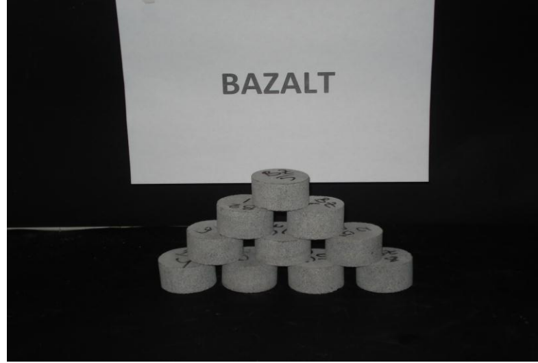
Şekil 3.7. Dolaylı çekme deneyi için hazırlanan tipik numuneler
