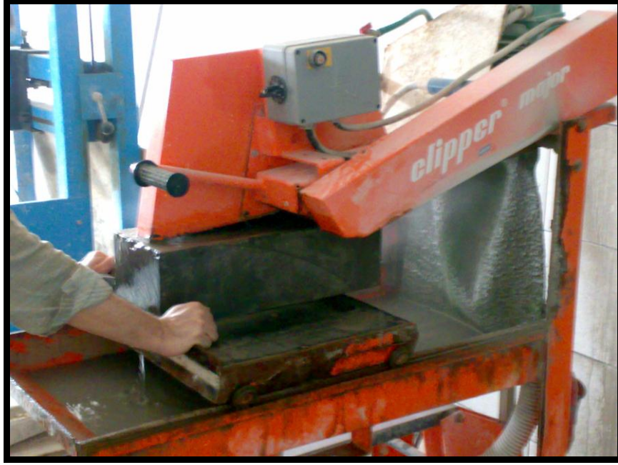
Şekil 3.9. Yapay titreşim deney numunelerinin hazırlandığı, blok kesme makinesi
