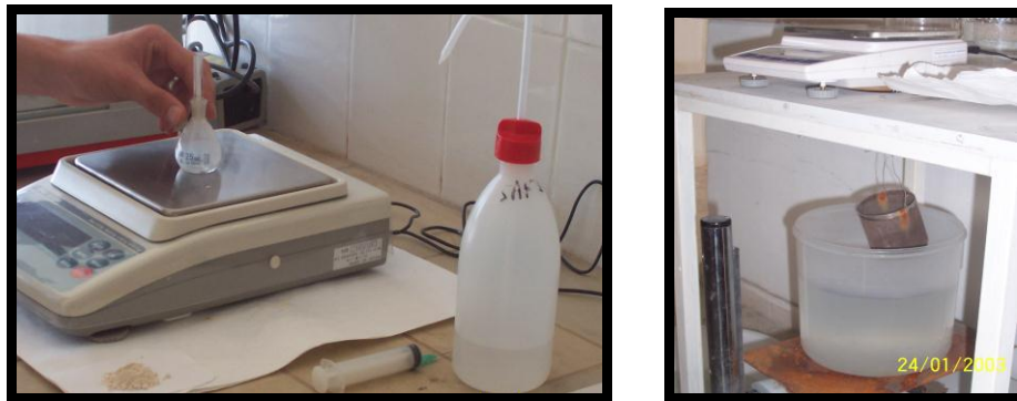
Şekil 4.1. Numunelerin yoğunluklarının belirlenmesi
