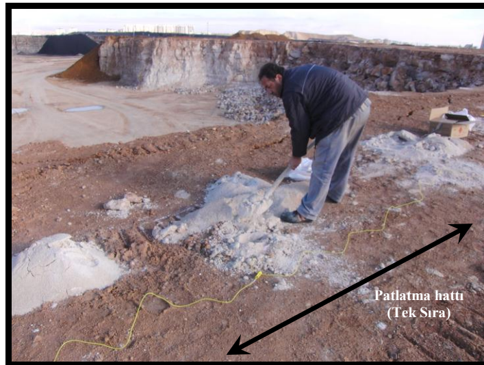
Şekil 7.8. Tek hat üzerinden patlatılmaya hazırlanan delik düzeni
