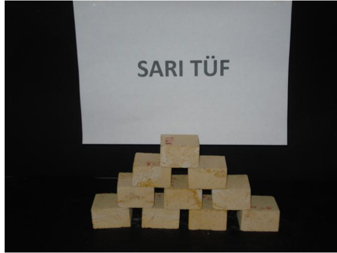
Şekil 3.4. Yoğunluk, gözeneklilik ve su emme kapasitesi belirleme deneyi numuneleri
