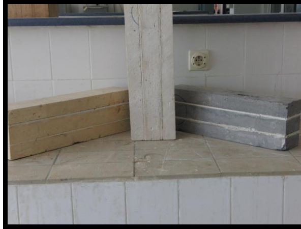
3.14b. Yapay titreşim kaynağının oluşturulduğu noktaya paralel oluşturulan süreksizliklerin fotoğraf görünüşü
