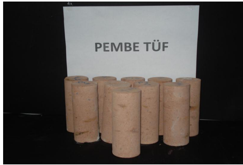
Şekil 3.6. Tek eksenli basınç dayanımı deneyi için hazırlanan tipik silindirik karot numuneler
