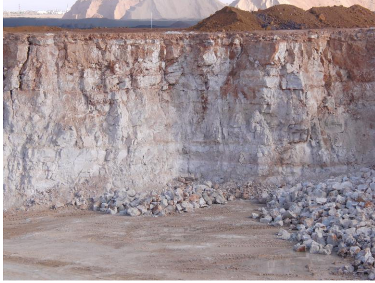
Şekil 7.19. Sahaya ait Farklı tabaka kalınlığına sahip ayna yüzeyi
