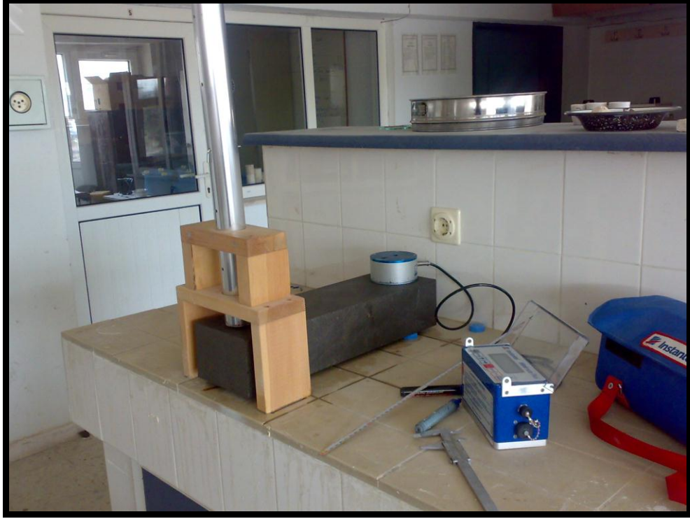
řekil 5.5. Doymun numune zerinde titreřim testlerinin yapılıřı
