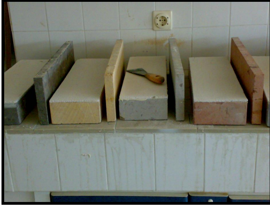
Şekil 5.3. Süreksizlik arası dolgu malzemelerinin yerleştirilişi
