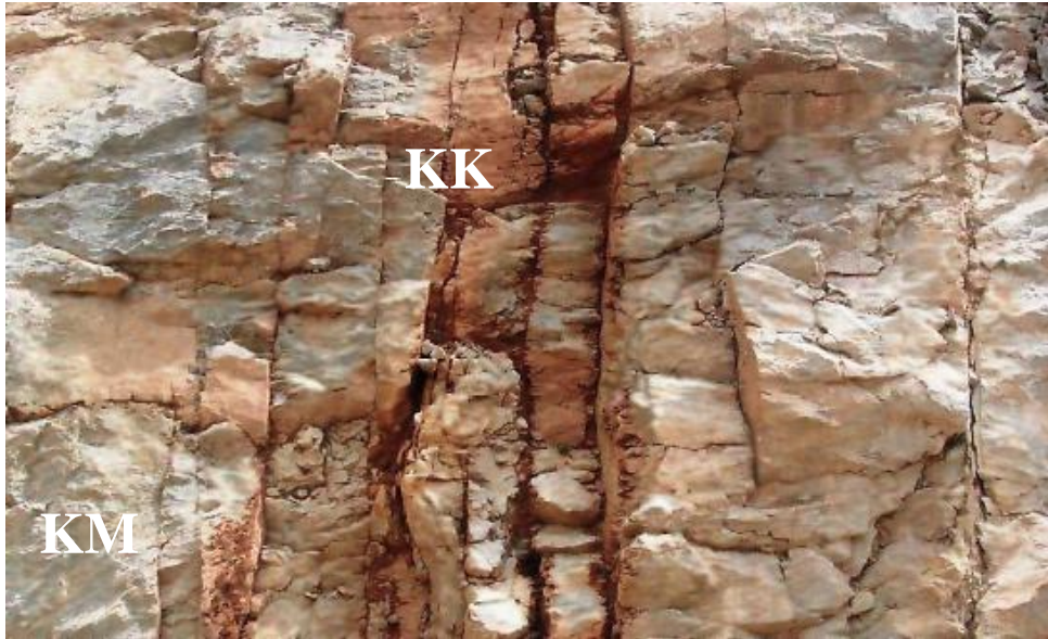
Şekil 2.33. Düşey tabakalanma düzlemlerinin yer aldığı bu kireçtaşı şevinde; KK: Kaya kütleleri olarak bütün fotoğrafı anlatırken, KM: Kaya maddesi olarak sadece ilgili kireçtaşı parçasını göstermektedir (Ak, 2006)
