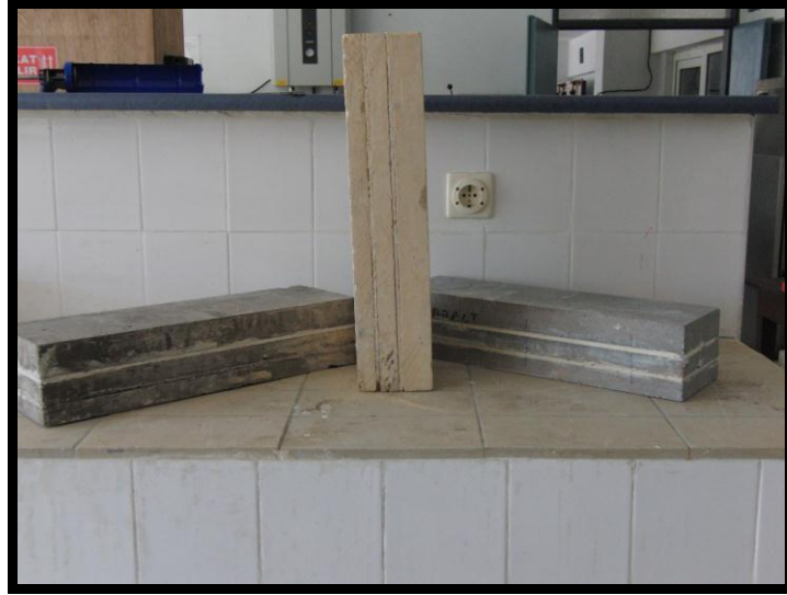
Şekil 3.16b. Yatay tabakalanmalı ve farklı tabaka kalınlığına sahip numunelerin fotoğraf görünüşü
