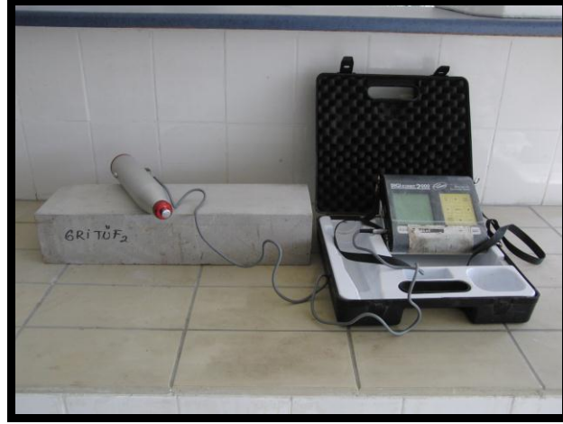
Şekil 4.2. Schmidt çekici ile sertlik değerlerinin belirlenmesi
