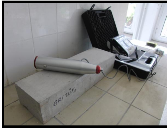
Şekil 3.5. Sertlik Belirleme testi numunesi ve elektronik hafızalı Schmidh çekici
