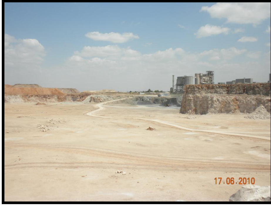
Şekil 7.18. Çalışma bölgesine ait alt ve üst basamak görünüşü
