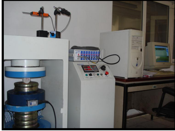
Şekil 4.4. 300 ton kapasiteli hidrolik pres
