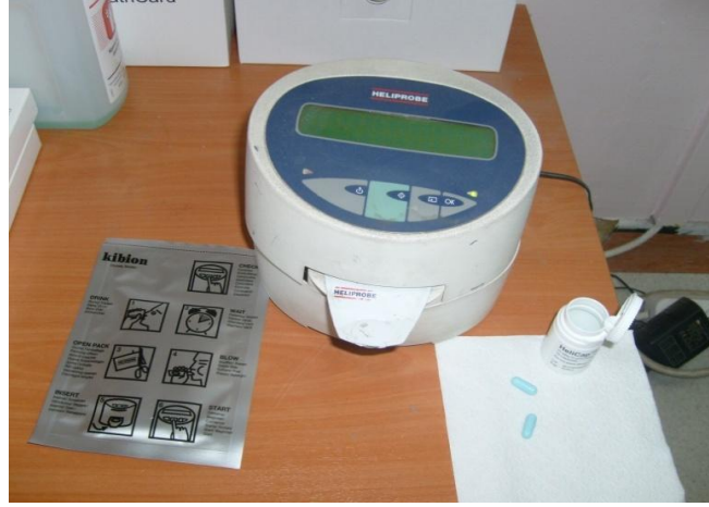
Şekil 2.18. Nefes kartuşlarının aktivitesini ölçen Geiger-Müller sayacının görünümü
