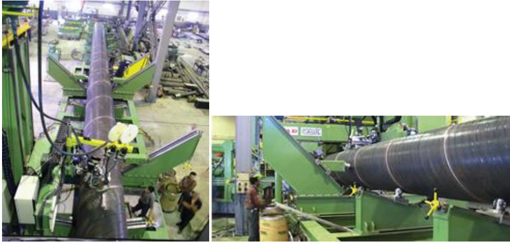
Şekil 5.1. Spiral boru kaynağı
