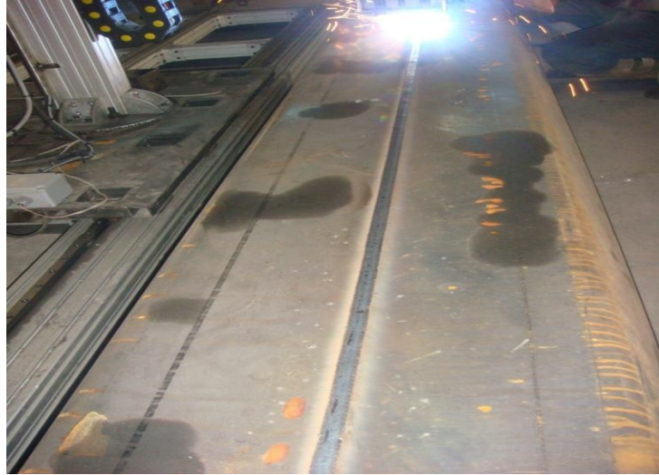
Şekil 7.17. Mekanik sensör ile boom kaynağı numunesi (ölçek 1:3)
