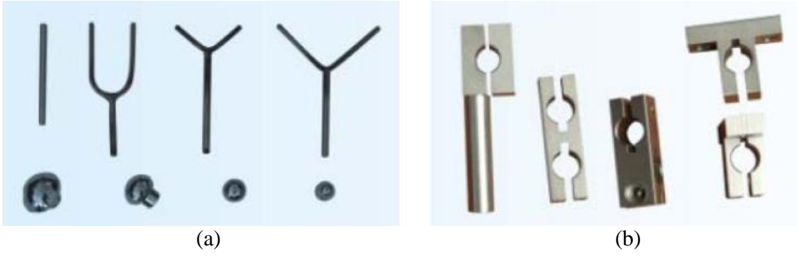
Şekil 6.7. a) mekanik sensör uçları b) bağlantı aparatları
