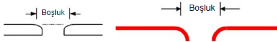
Şekil 5.8. Yuvarlak kenarlı izin birleşme yeri ve ölçümü
