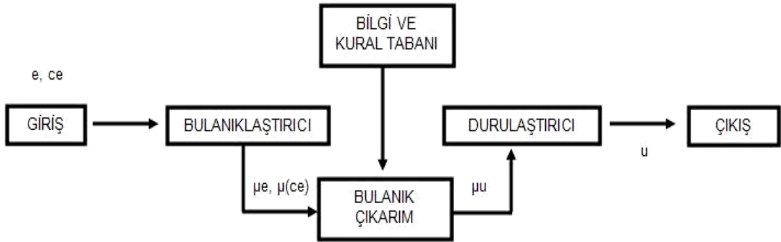
Şekil 3.4. Bulanık mantık denetleyicisinin blok diyagramının konfigürasyonu
