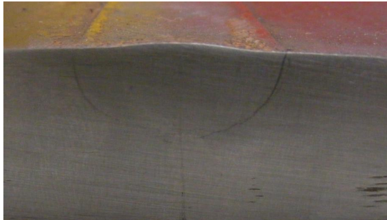
Şekil 7.18. Mekanik sensör ile boom kaynağı numunesi ITAB bölgesi (ölçek 2:1)
