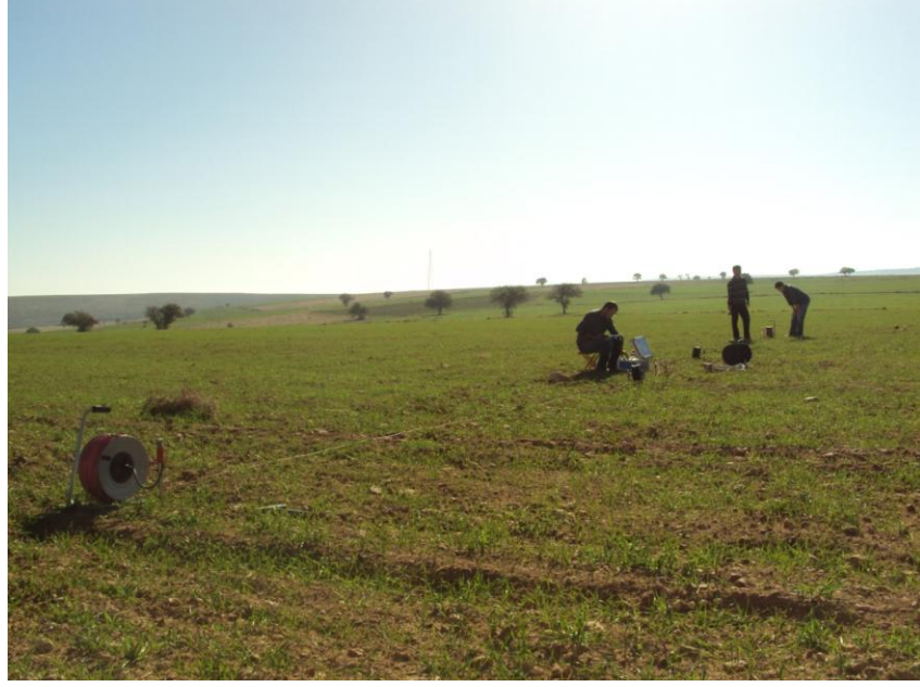
Şekil 4.29. Hatip-Çayırbağı ikinci noktadaki rezistivite çalışması
