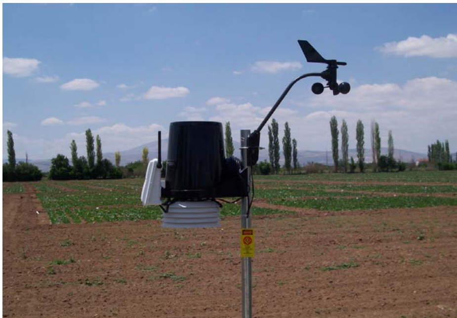
Şekil 3.2. Deneme arazisine kurulan portatif meteoroloji istasyonu
