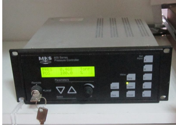
Şekil 3.14. Basınç göstergesi ve kontrol ünitesi
