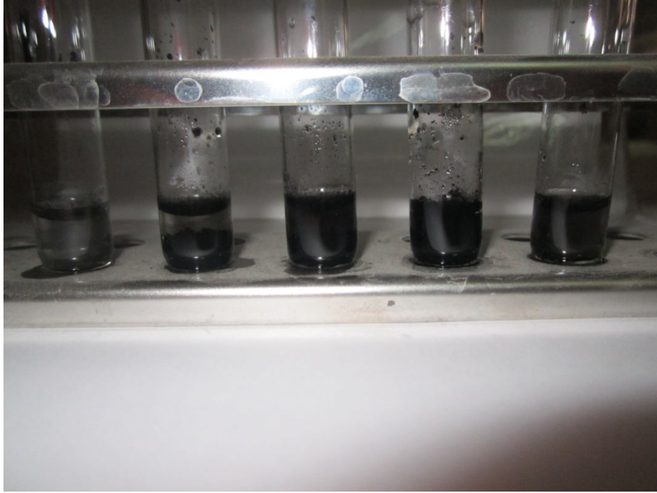
Şekil 4.32. Boş, 500nm, 1000nm, 2000nm ve 4000nm kaplı CNT'nin suda dağılımı (soldan sağa)
