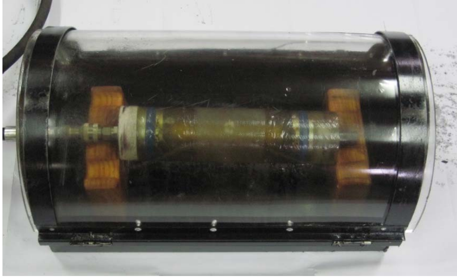
Şekil 6.12 İç basınç test aparatı yerleştirilmiş deney numunesi ve muhafaza kabini
