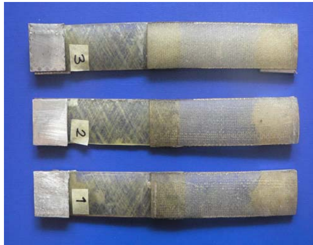
Şekil 6.19 Tek bindirmeli birleşim deney numuneleri (Günaydın 2010)
