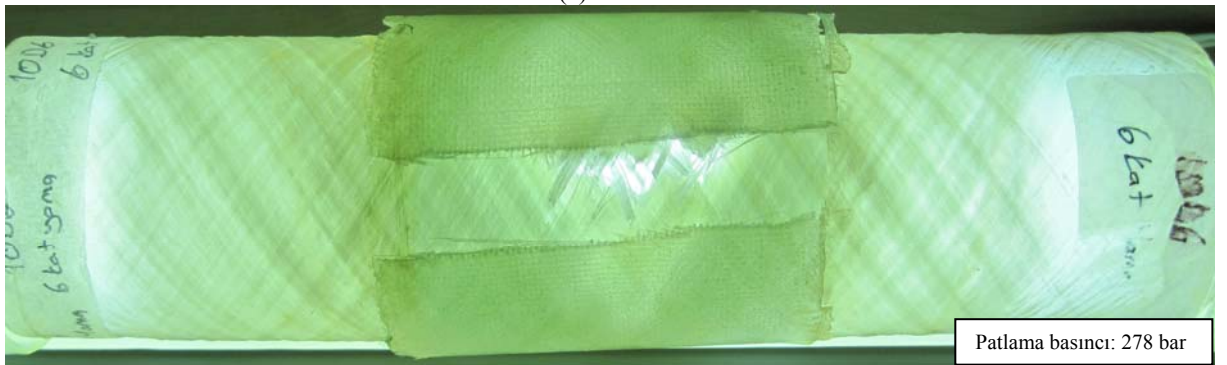
Şekil 7.26 10 J darbe enerjisiyle hasarlandırılmış ve hasar bölgesi sırasıyla a) Yamasız b) 2 kat yama c) 4 kat yama d) 6 kat yama yapılmış boruların statik iç basınç patlama testi sonucunda elde edilen son hasar fotoğrafları
