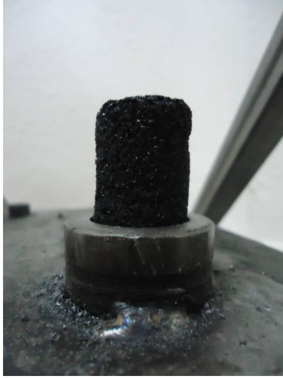
Şekil 5.8. Tutucu içerisinde yerleştirilmiş deney numunesi
