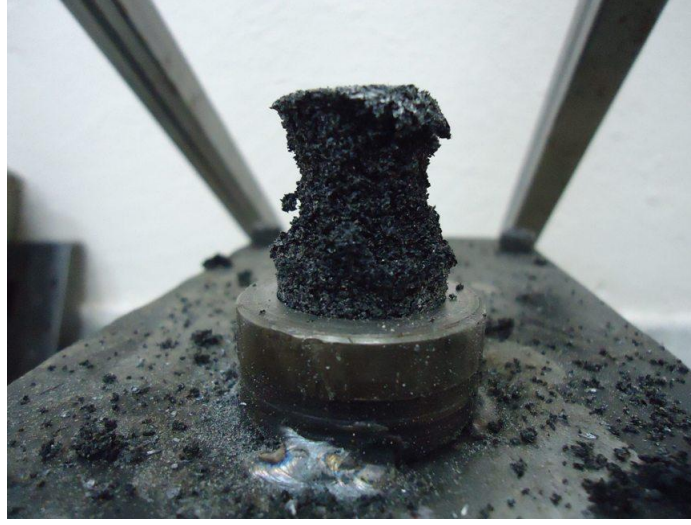
Şekil 6.4 Ağırlıkça % 60 granül kauçuk içeren numunenin darbeden sonraki görüntüsü
