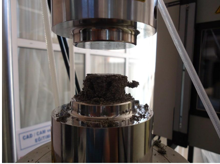
Şekil 6.36 Çelik talaşı içeren numunenin basma deneyi sonrası durumu
