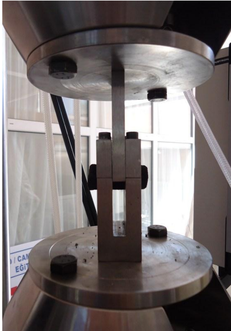
Şekil 6.45 Granül kauçuk karışımli numunenin kesme deneyi görüntüsü
