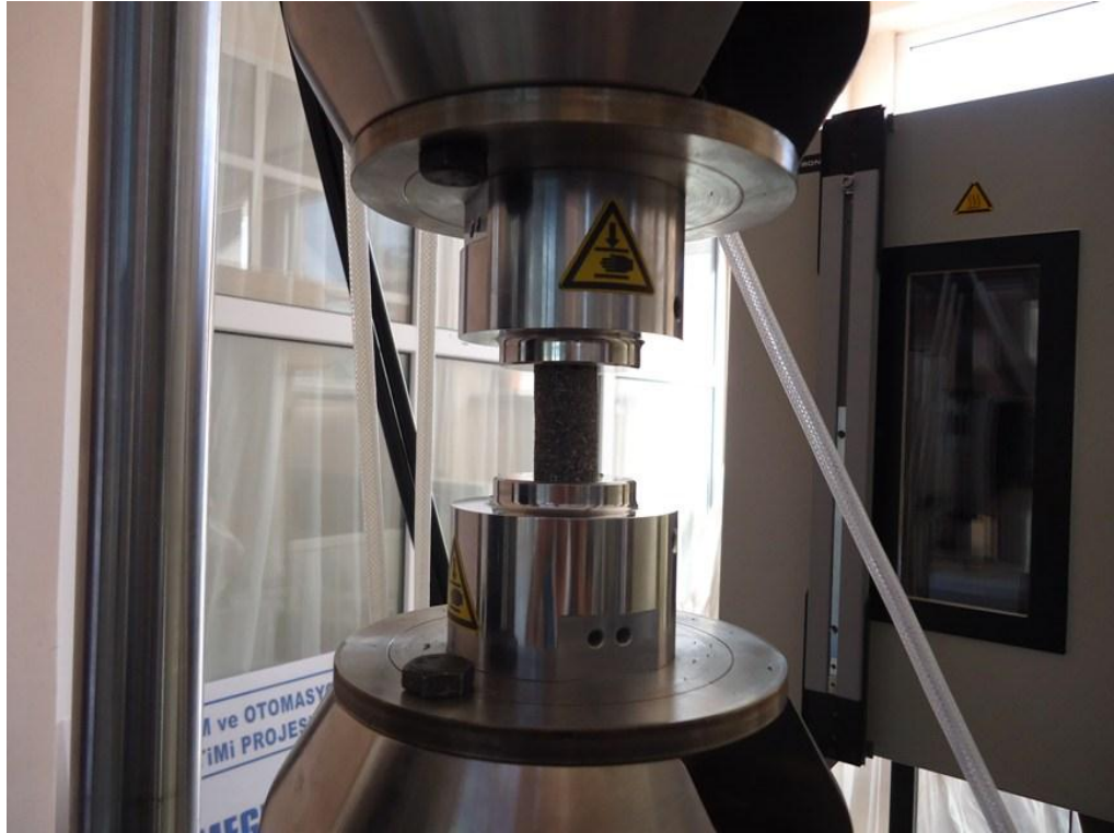
Şekil 6.25 Basma deneyine hazır test numunesi
