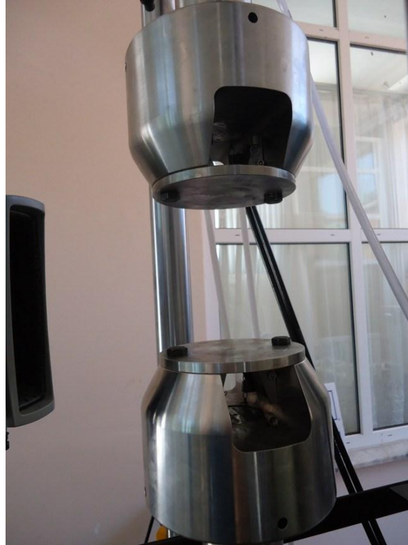
Şekil 6.37 Kesme deneyi için çekme çenelerine takılmış düz plakalar
