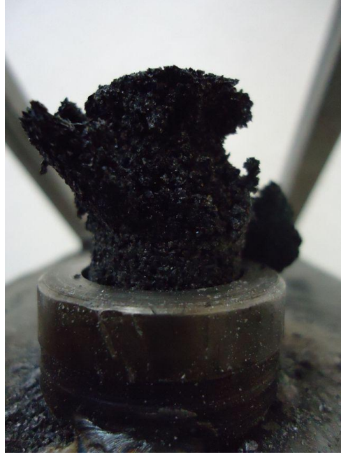
Şekil 6.2 Ağırlıkça % 50 granül kauçuk içeren numunenin darbeden sonraki görüntüsü
