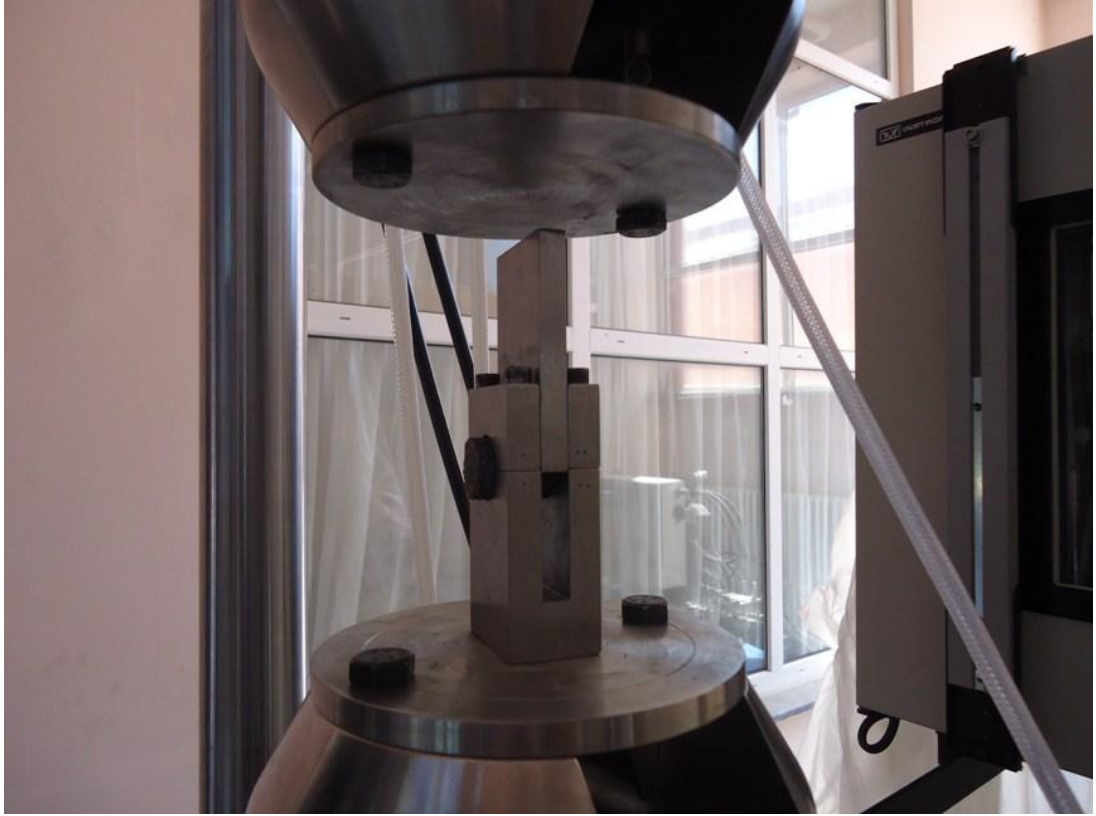
Şekil 6.38 Kesme deneyi düz plakaları arasına konmuş kesme aparatı
