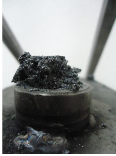
Şekil 6.11 Ağırlıkça % 60 çelik talaşı içeren numunenin darbeden sonraki görüntüsü
