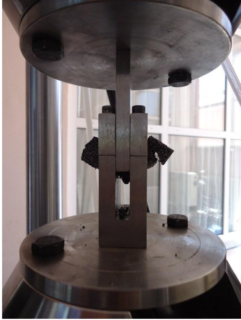
Şekil 6.50 Çelik talaşı karışımı numunenin kesme deneyi görüntüsü
