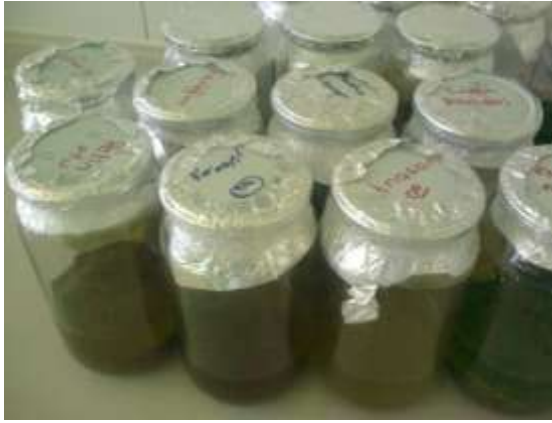
Şekil 3.6. Methanolde bekletilen öğütülmüş bitki kısımlarının bulunduğu kavanozlar.
