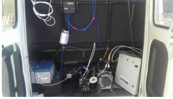
Şekil 3.13. DC motor ve sürücüsünün taşıt içerisindeki yerleşimi
