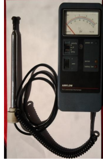
b. Kalibrede kullanılan Airflow TA2 hava hızı ölçüm cihazı
