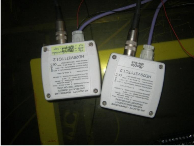
a. AT-HD29V371TC1.2 tip Delta-Ohm hava ölçer
