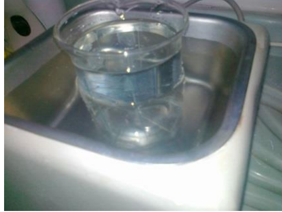
Şekil 3.1 Camların ultrasonik banyoda yıkanması
