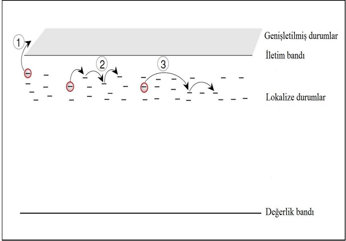
Şekil 2.4 n-tipi yarıiletken için akım iletim mekanizmalarının şematik gösterimi,
