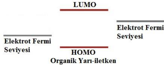
Şekil 1.13 TOF ölçümü için gereken ideal enerji seviyeleri diagramı
