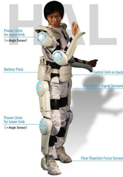
Şekil 2.6. Cyberdyne tarafından geliştirilen HAL-5
