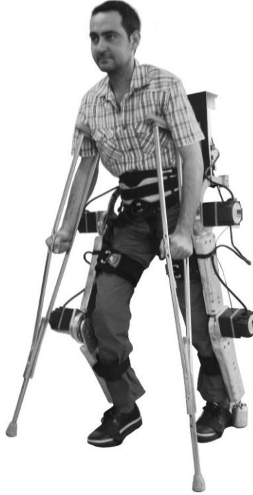
Şekil 2.17. YÜDİS dış iskelet sistemi
