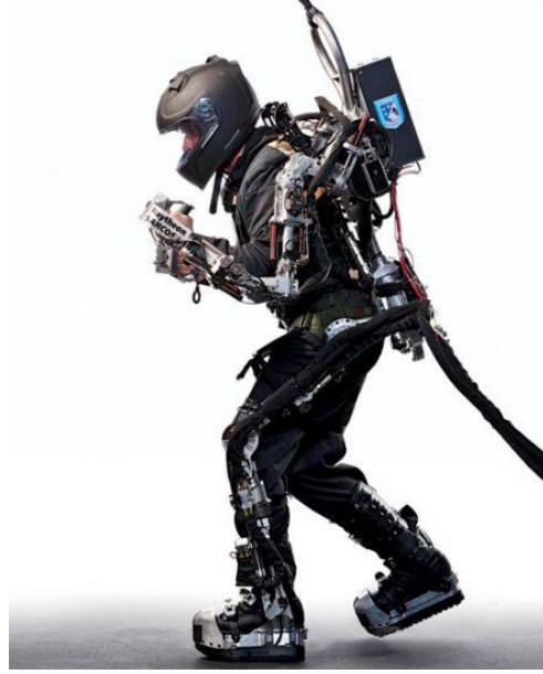
Şekil 2.4. Raytheon Sarcos tarafından geliştirilen XOS
