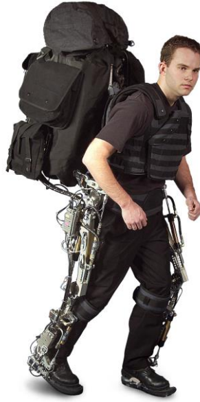
Şekil 2.1. Berkeley Alt Ekstremler Dış İskelet (BLEEX)
