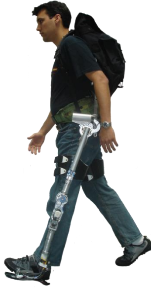
Şekil 2.5. MIT tarafından geliştirilen dış iskelet
