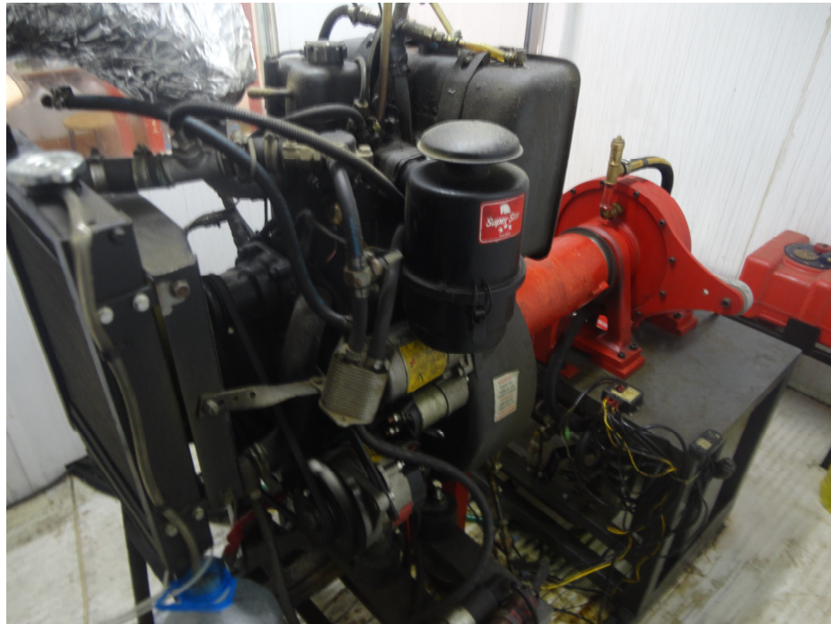
Şekil 3.1. Deney motoru ve hidrolik dinamometre
