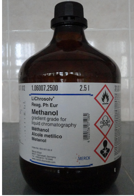
Şekil 3.25. Aspir biyodizeli üretiminde kullanılan alkol
