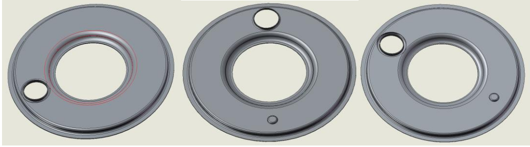
Şekil 3.21. Ön yoğuşturucu üst, alt ve son plakaları
