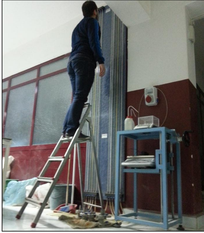
Şekil 7.10 Düşen seviyeli permeametre testlerinden bir görünüm
