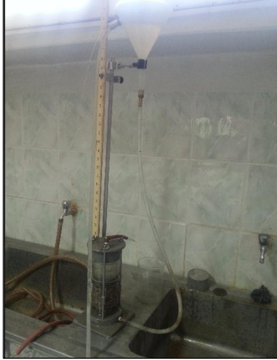
Şekil 7.9 Sabit seviyeli permeametre testlerinden bir görünüm
