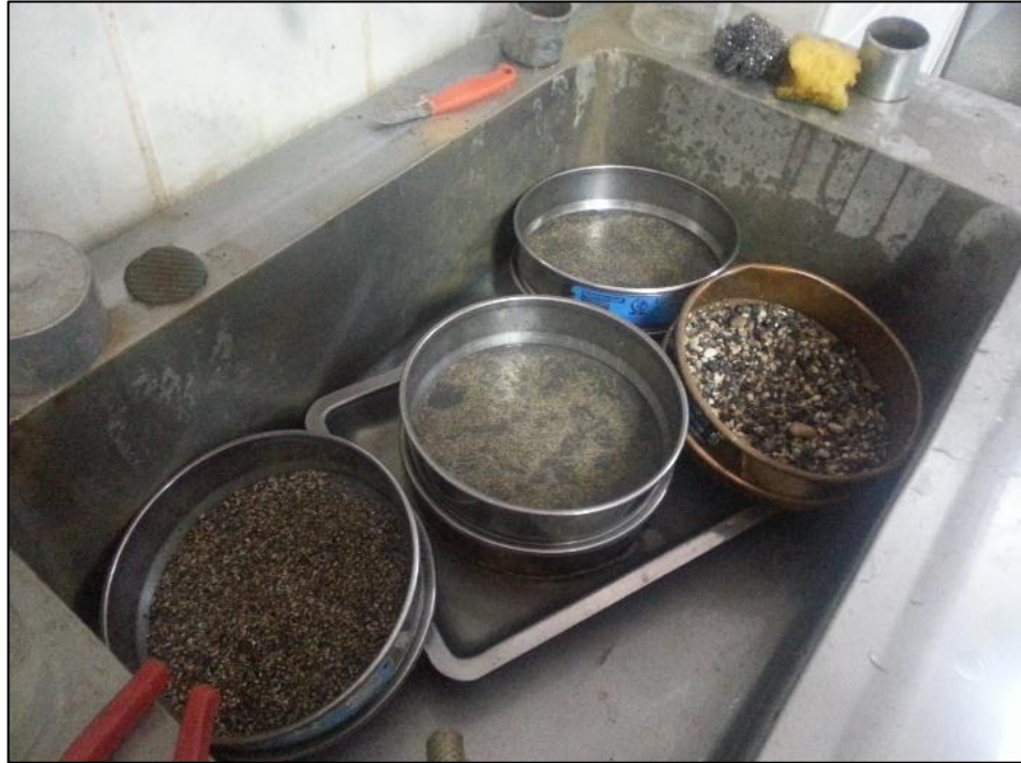
Şekil 7.7 Sondaj numunelerinde gerçekleştirilen elek analizleri
