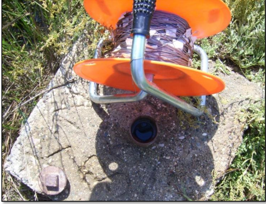
Şekil 4.6 Devlet Su İşleri tarafından açılan dar çaplı sığ gözlem kuyusu
