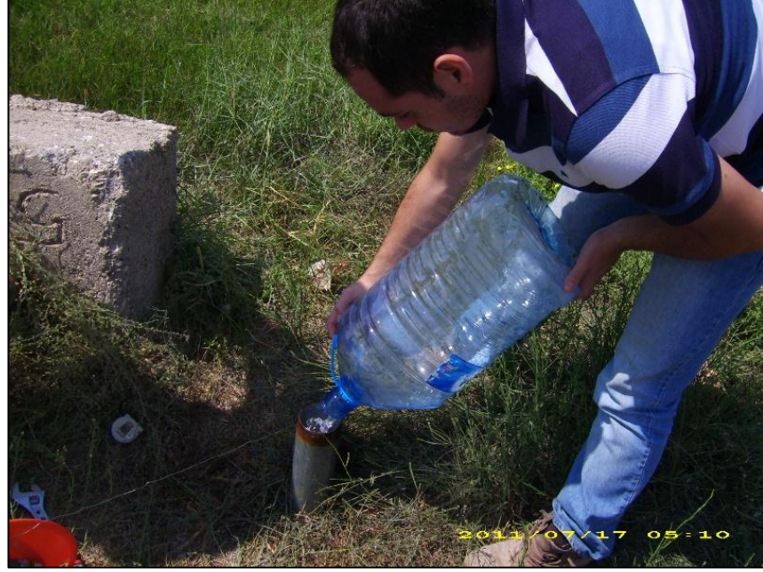
Şekil 7.5 Tez kapsamında uygulanan slug testlerinden görünüm (MST4 nolu kuyu)
