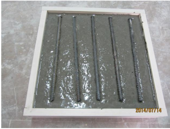
c) Üst sıra donatılarının yerleştirilmesi
