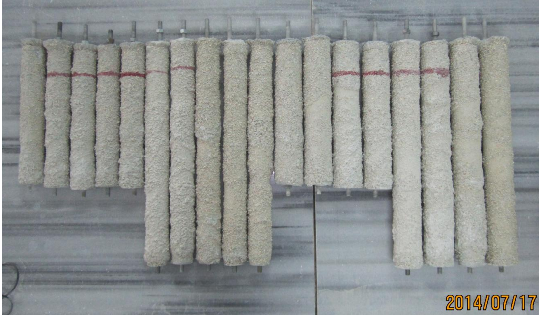
(b) Soldan sağa doğru: D60 L400 (5 adet), D60 L600 (5 adet), D70 L400 (4 adet) ve D70 L600 (4 adet). Resimde kazıkların alt ucuna yük hücresi, üst tarafına ise plaka monte etmek için yer alan vidalar ile tank içerisinde yerleştirilen zemin seviyesini ayarlayabilmek için çizilen kırmızı çizgiler yer almaktadır.
