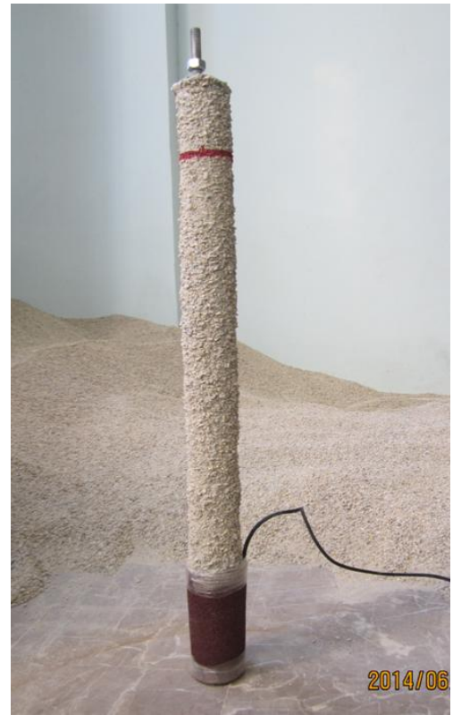
Şekil 4.18. Tekil kazık—D60, L600. Yük hücresinin zımpara kağıdıyla çevrelenmesi
