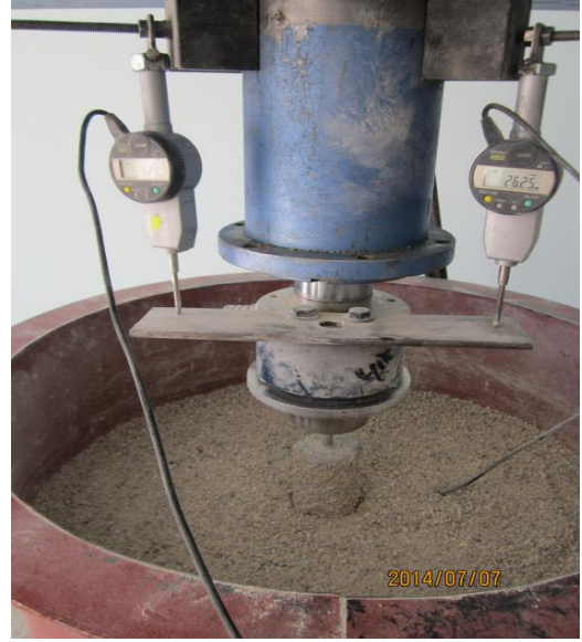
Şekil 4.20. Tekil kazık— D70, L600. Yükleme durumu
