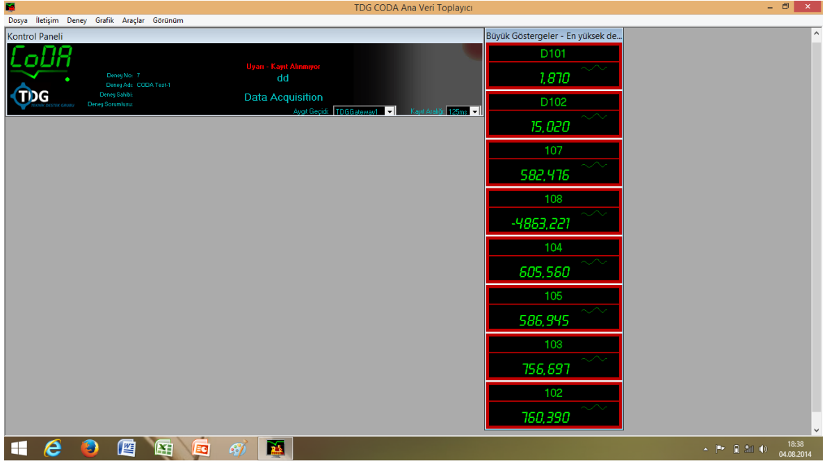
Şekil 4.39. Radye temel altına üç kazık uygulamasına ait yük-oturma verilerinin kaydedilmesi
