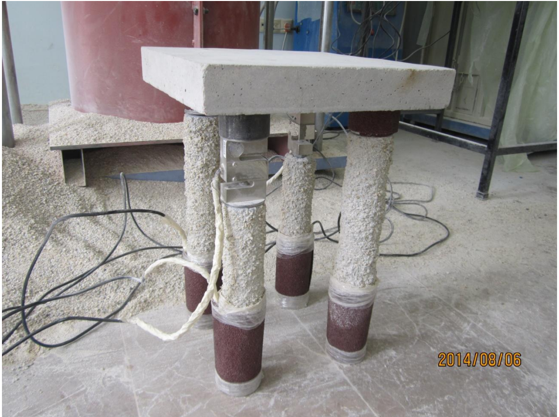
Şekil 4.40. Kazıklı radye sistemi—B320, L320, n=4, D60, L4000, s=3D
