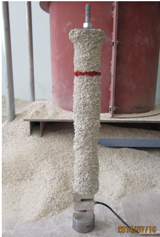
Şekil 4.17. Tekil kazık—D60, L400. Yük hücresinin kazık ucuna monte edilmesi
