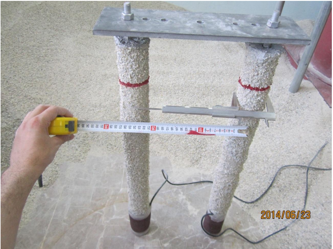
Şekil 4.21. İki kazıktan oluşan kazık grubu—D60, L600, s=4D . Aynı şekilde yukarıdaki levha kullanılarak farklı çap ve boydaki kazıklar 2D, 3D ve 4D kazık aralığında monte edilmiştir.
