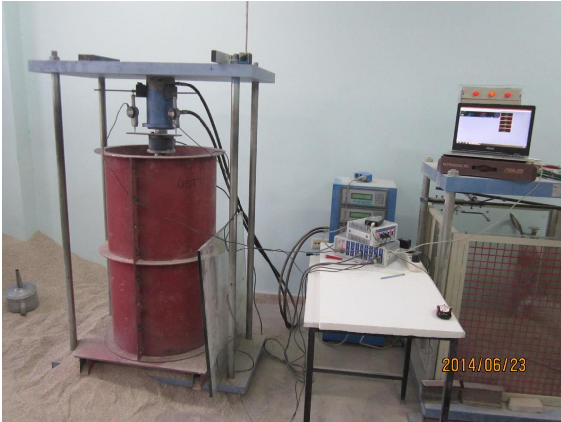
Şekil 4.9. Soldan sağa doğru—yükleme sistemi ve deney tankı, veri toplama ünitesi ve verilerin bilgisayar ortamına aktarılması
