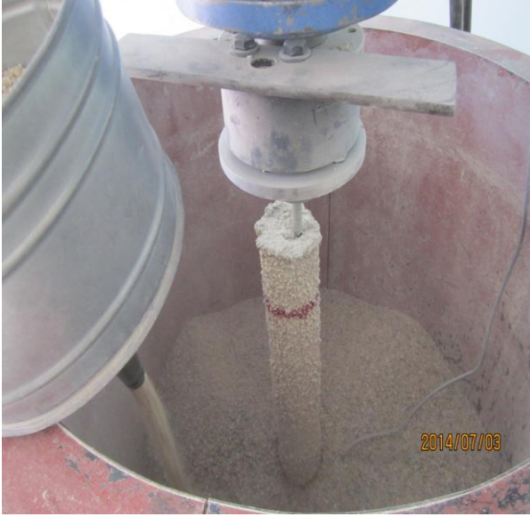
Şekil 4.19. Tekil kazık— D70, L400. Zeminin yerleştirilmesi
