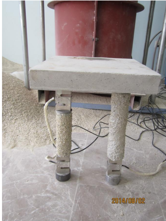
Şekil 4.36. Kazıklı radye sistemi—B320, L320, n=2, D60, L400, s=3D
