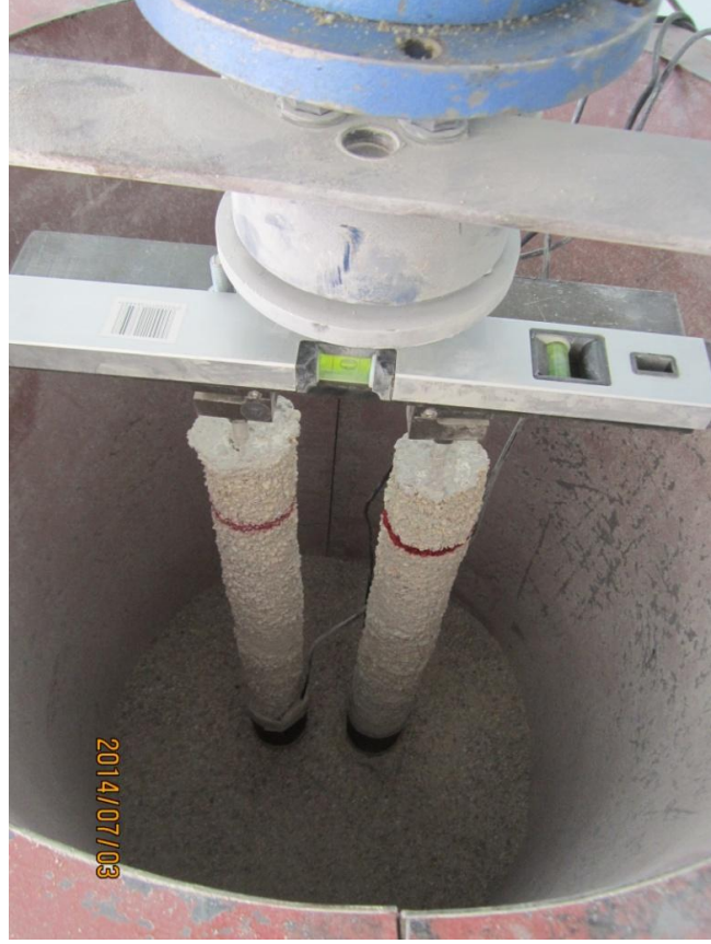
Şekil 4.22. İki kazıktan oluşan kazık grubu—D60, L600, s=2D. Kazıkların tankın içerisine yerleştirilmesi ve düşeyliğinin kontrolü
