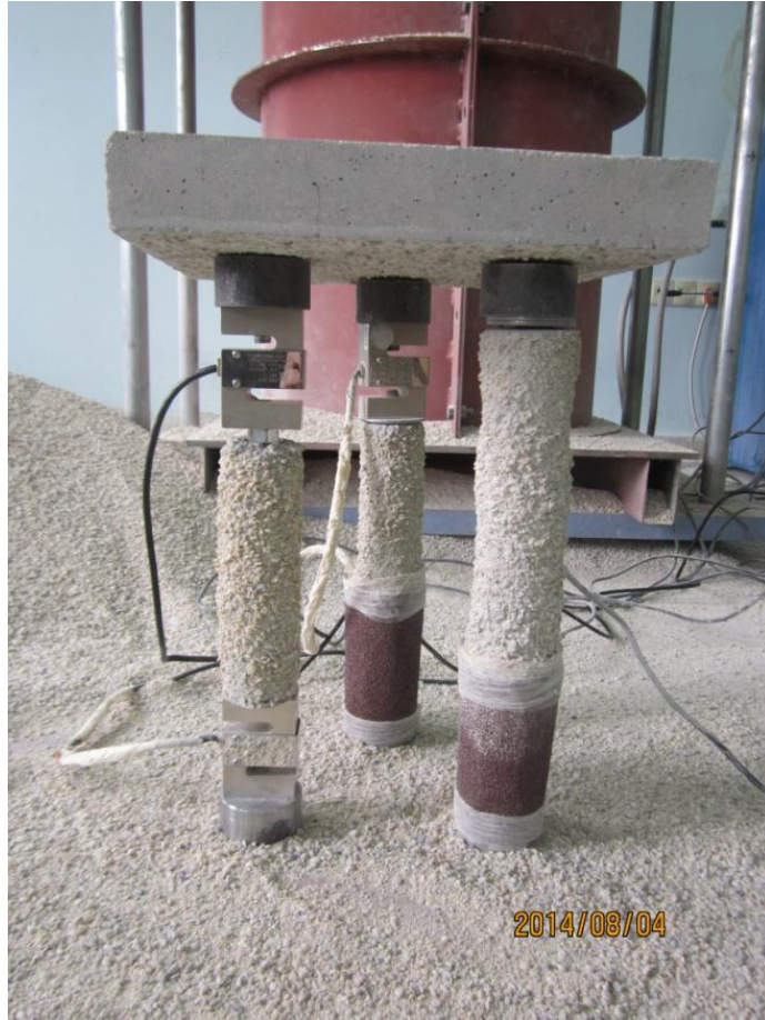
Şekil 4.38. Kazıklı radye sistemi—B320, L320, n=3, D60, L400, s=3D
