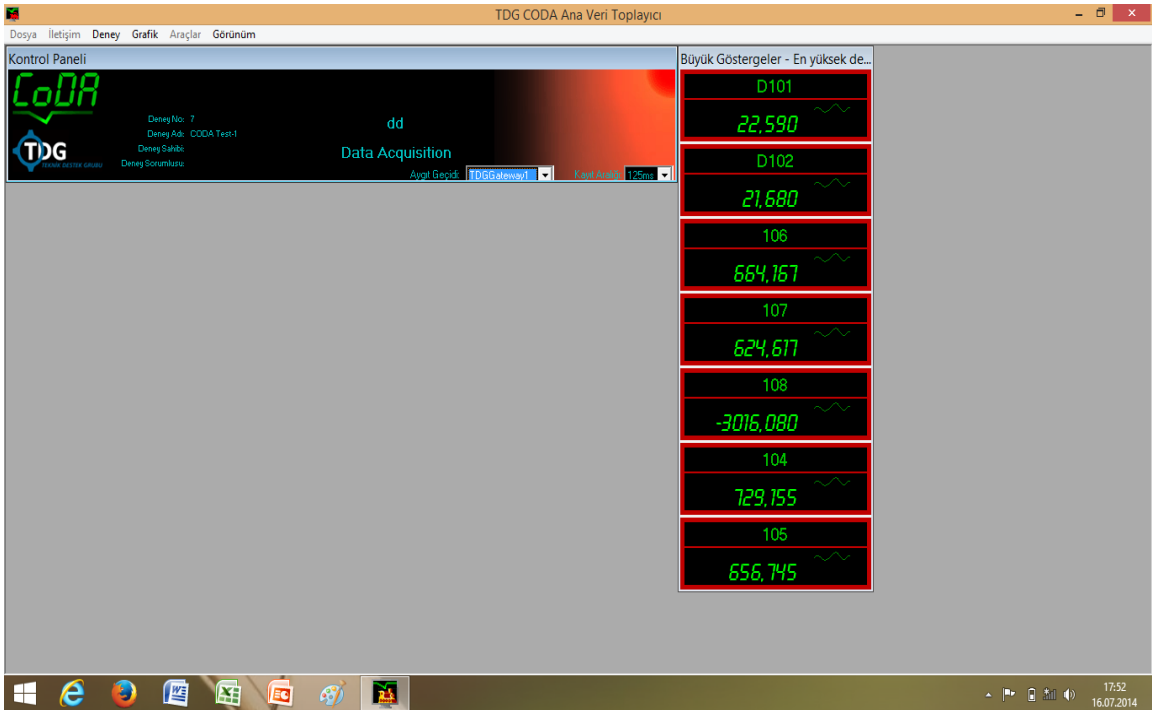
(b) Yükleme sırasında yük-oturma verilerin kaydedilmesi—D101 ve D102 kazık grubunun oturmasını, 104, 105, 106 ve 107 kazık uçlarında bulunan yük hücrelerinin ölçtüğü değerleri, 108 ise kazık grubunun taşıdığı toplam yükü göstermektedir.
