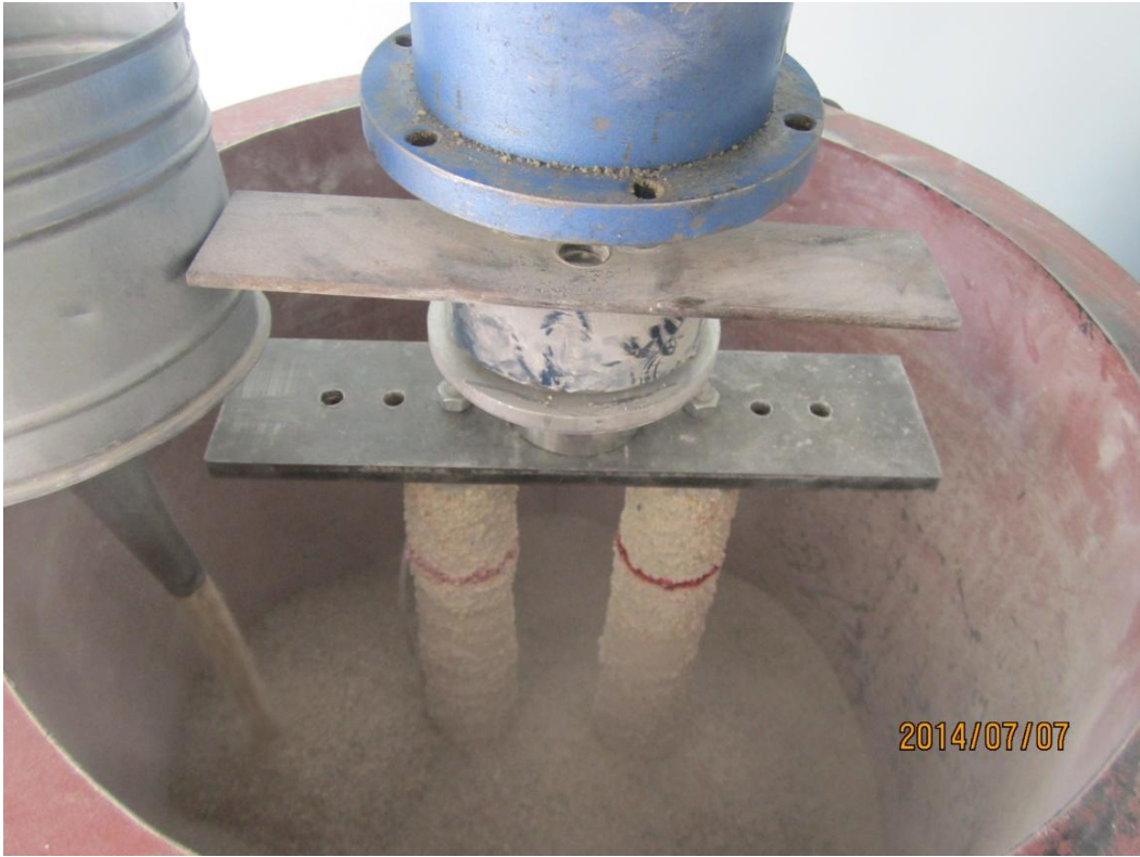
Şekil 4.23. İki kazıktan oluşan kazık grubu—D60, L400, s=2D. Kazık çevresinin zeminle doldurulması
