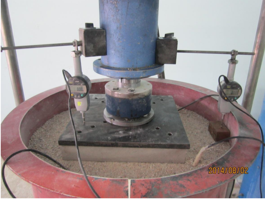
Şekil 4.35. Radye temelin yüklenmesi ve deney kumundaki oturmaların ölçülmesi
