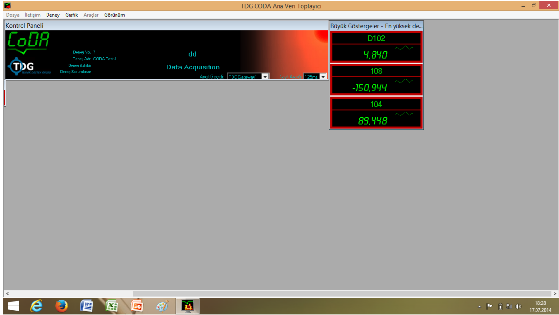
Şekil 4.13. Tekil kazık yükleme deneyinde verilerin bilgisayarda depolanması—deney sırasında 4.84 mm oturma anındaki (D102) kazığın taşıdığı toplam yük (108) ve kazık ucuna aktarılan yük (104)
