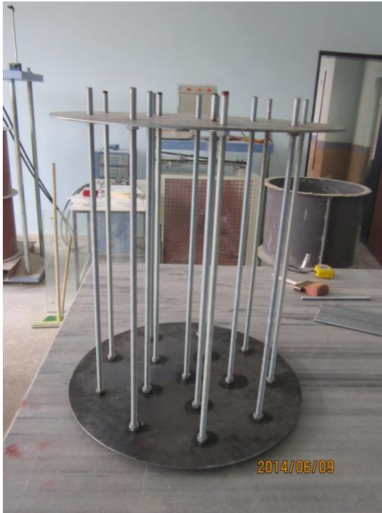
Şekil 4.2. Kazık eksenindeki vidaların sabitlenmesi
