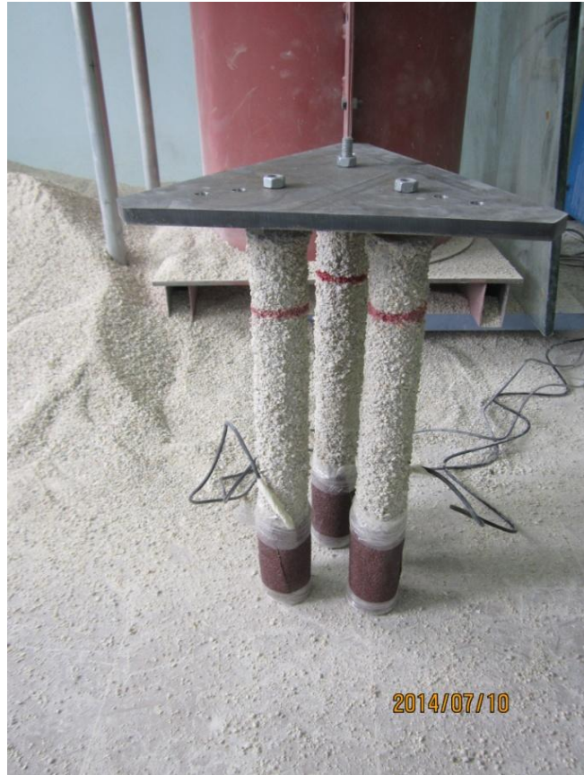
Şekil 4.25. Üç kazıktan oluşan kazık grubu—D60, L400, s=2D. Aynı şekilde bu kazıklar kullanılarak kazıklar 3D ve 4D kazık aralıklarında monte edilmiştir.
