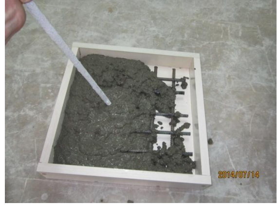
b) Betonun dökülmesi ve şişilmesi
