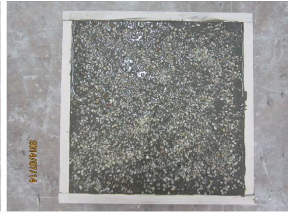
d) Temel tabanının pürüzlendirilmesi
