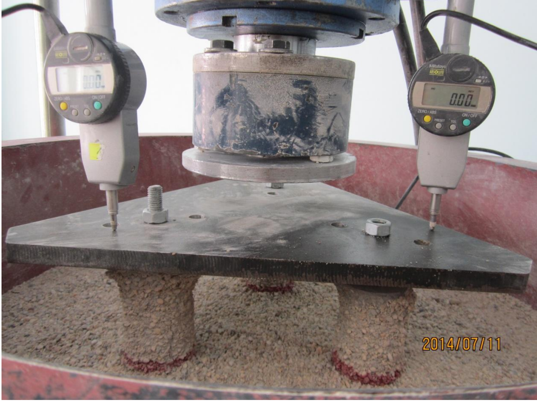
Şekil 4.27. Üç kazıktan oluşan kazık grubu—D60, L400, s=3D
