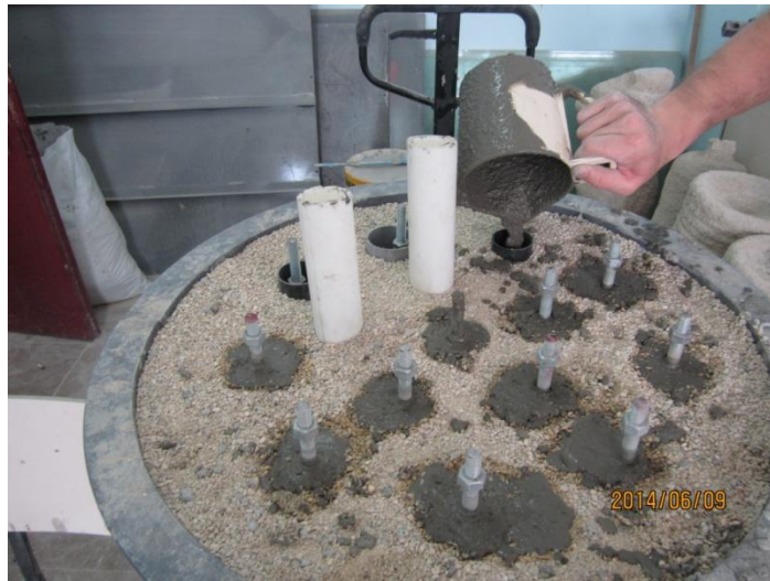
Şekil 4.6. Muhafaza borularının çekilmesi ve beton dökme işlemi
