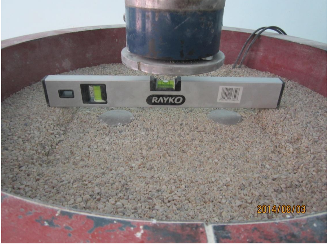
Şekil 4.37. Kazıklı radye sisteminde üniform oturma—B320, L320, n=2, D60, L400, s=3D.
