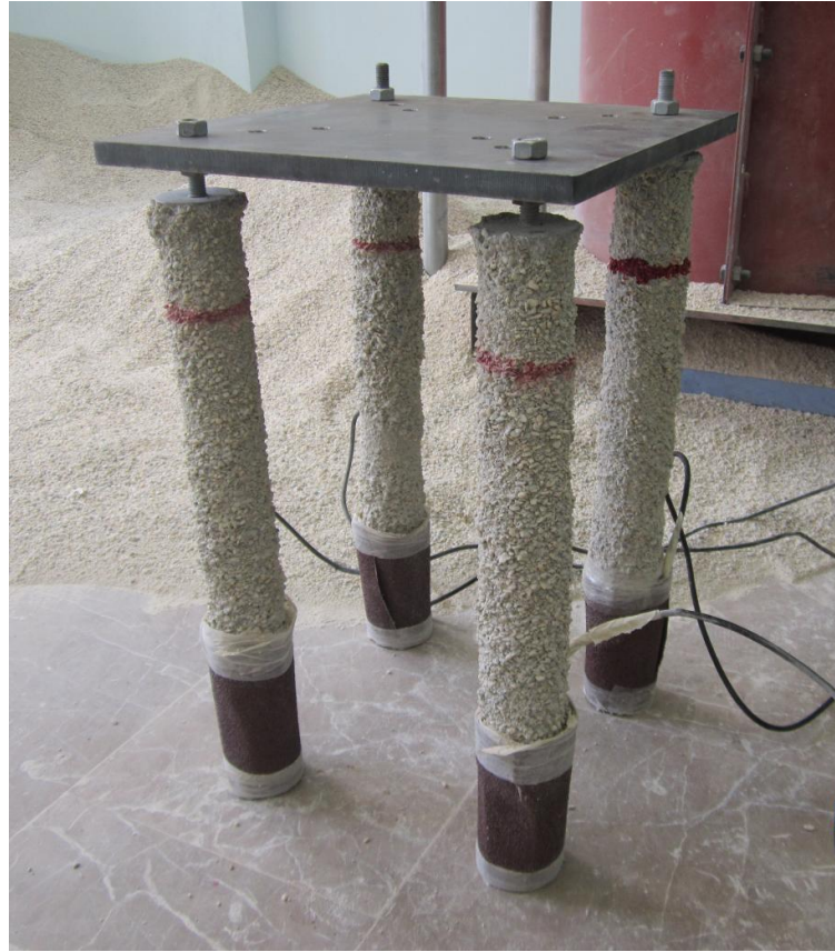
Şekil 4.28. Dört kazıktan oluşan kazık grubu—D60, L400, s=4D. Aynı şekilde bu kazıklar kullanılarak kazıklar 2D ve 3D kazık aralıklarında monte edilmiştir.
