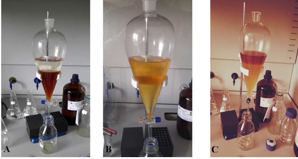
Şekil 4.4.2.4. (A) T. anaticum -MetOH ile Hekzan karışımının ayırma hunisindeki faz farkı, (B) T. anaticum -MetOH ile Kloroform karışımının ayırma hunisindeki faz farkı, (C) T. anaticum MetOH ile Etil Asetat karışımının ayırma hunisindeki faz farkı
