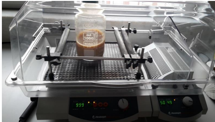
Şekil 3.3.2.2. T. anaticum (TA) ve %70 MetOH karışımının 50 °C sıcaklıkta 150 rpm de 24 saat shaker cihazında işleme tabii tutulması.
