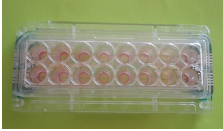
Şekil 3.12.1.1. Xcellingence Sistem Gerçek Zamanlı Hücre Analizinde kullanılan E-plate
