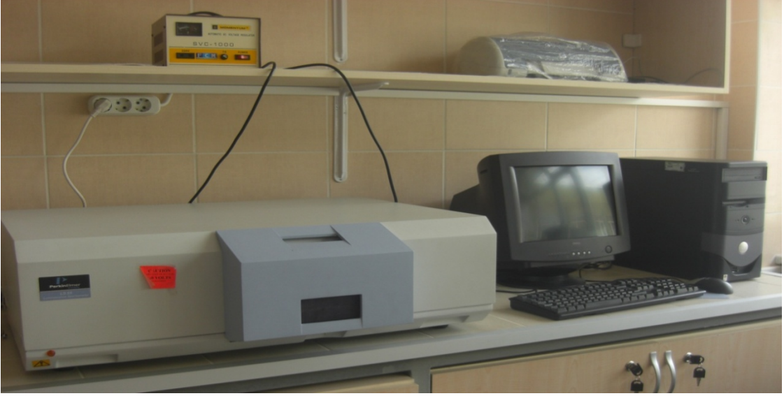
Şekil 2.15. Fotolüminesans ölçümleri için kullanılan cihaz.
