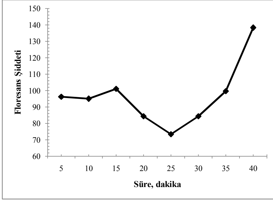
Şekil 5.8. Siprofloksasin-Fe(III) kompleksinin floresans şiddetine kompleks oluşum süresinin etkisi (Deney koşulları: [CIP] = 10^{-3} M, [Fe^{3+}] = 10^{-4} M, pH = 5.5, su ortamı, \lambda_{uy} = 370 nm, \lambda_{em} = 462 nm).
