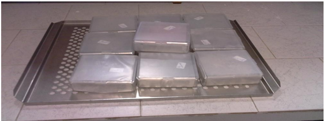
Şekil 3.2 Streç filmle kapatılmış yaşlandırma kutuları inkübatörlerin bırakılmadan önceki hali
