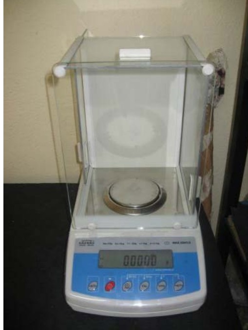
Şekil 3.11. Hassas Terazi (0,0001gr hassasiyetli)
