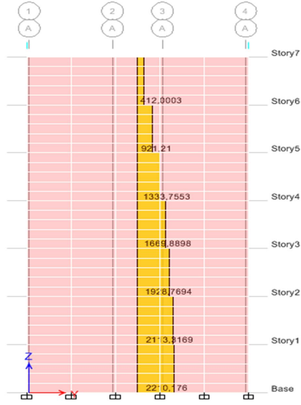
Şekil 4.52. Perde- çerçevesi binada EY yüklemesinde boşluksuz perde duvarda oluşan kesme kuvveti diyagramı
