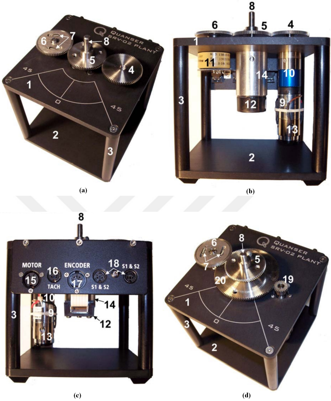
Şekil 3.25. (a) Servo sistemin düşük dişli oranındaki bileşenlerinin görüntüsü, (b) Servo sistemin bileşenlerinin önden görüntüsü, (c) Servo sistemin bağlantı girişlerinin görüntüsü, (d) Servo sistemin yüksek dişli oranındaki bileşenlerinin görüntüsü (Quanser, 2011)
