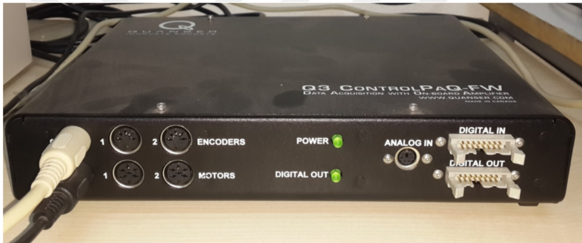
Şekil 3.30. Servo sistemin veri toplama ve güç ünitesi
