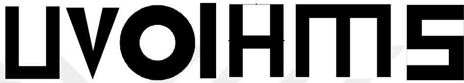
Şekil 2.9: Mikroşerit anten üzerine uygulanan çeşitli yarık şekilleri
