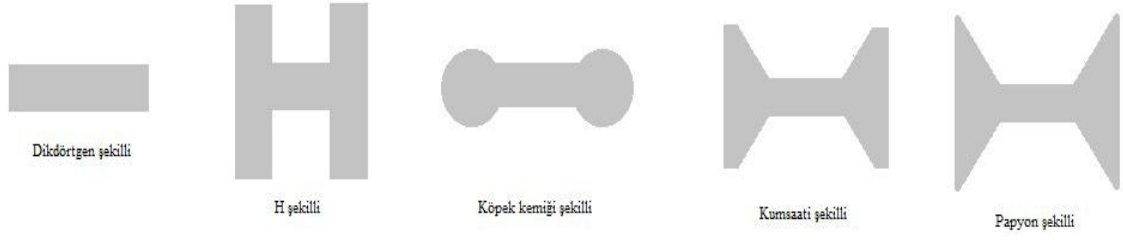
Şekil 2.5: Yaygın kullanılan açıklık şekillerinden bazıları
