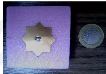
Şekil 3.33: Uygulaması gerçekleştirilen yalın ve V-yarık ilaveli SYMŞA Tasarımları
