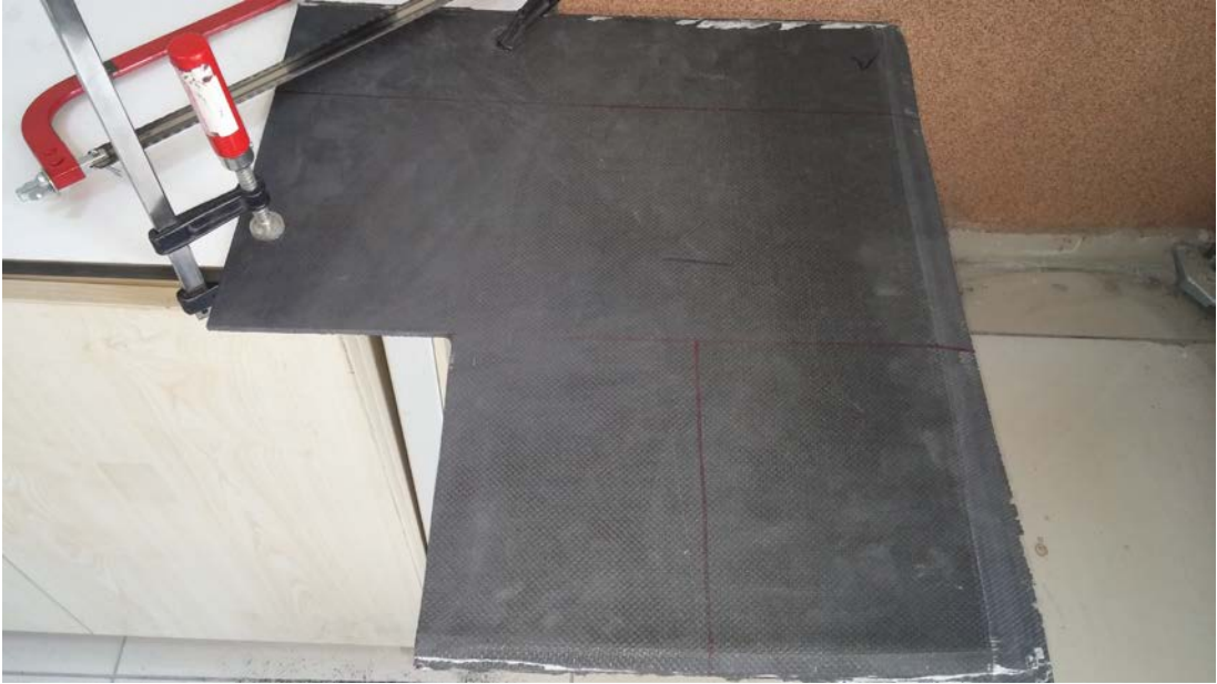
Şekil 6.1. CFRP plakanın kalıba uygun boyutta kesilmesi
