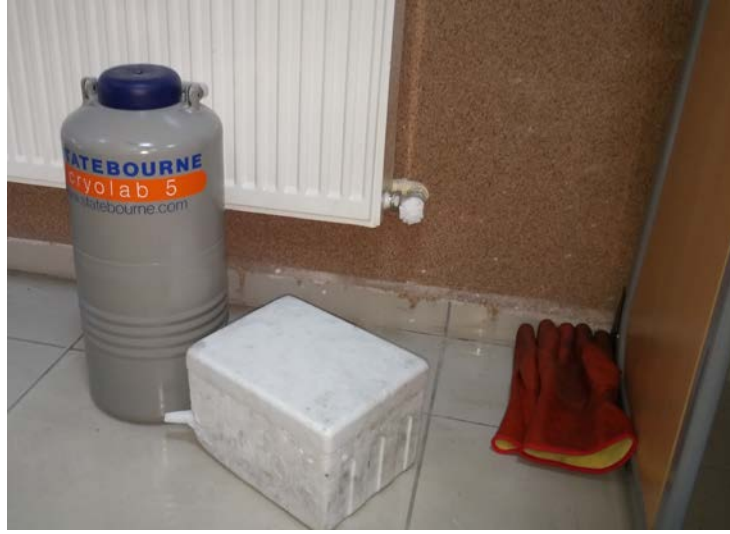
Şekil 6.9. Sıvı nitrojen tankı
