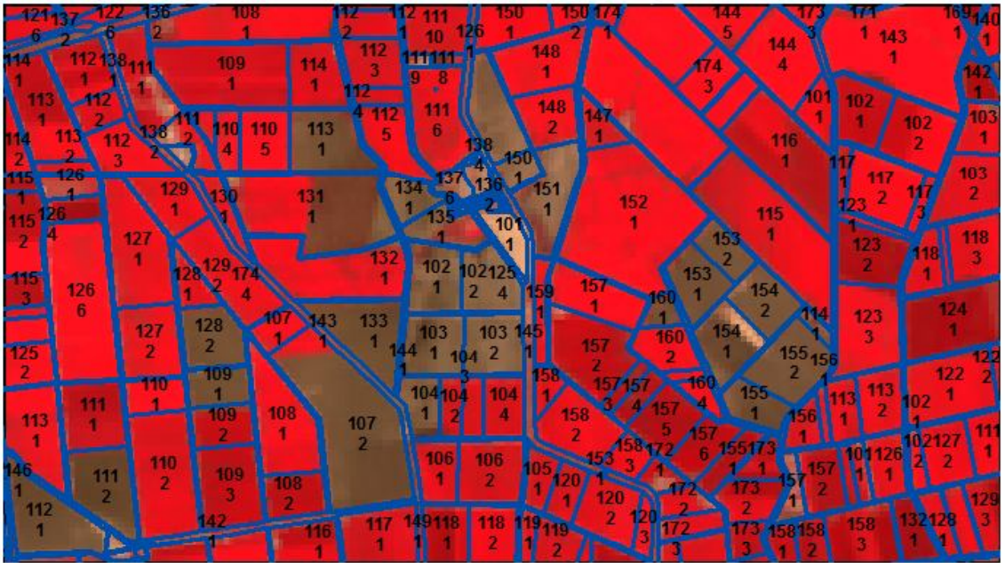
Şekil 6.20. 30/08/2013 tarihli LANDSAT-8 görüntüsü ile kadastro parsellerinin çakıştırılmış görüntüsü
