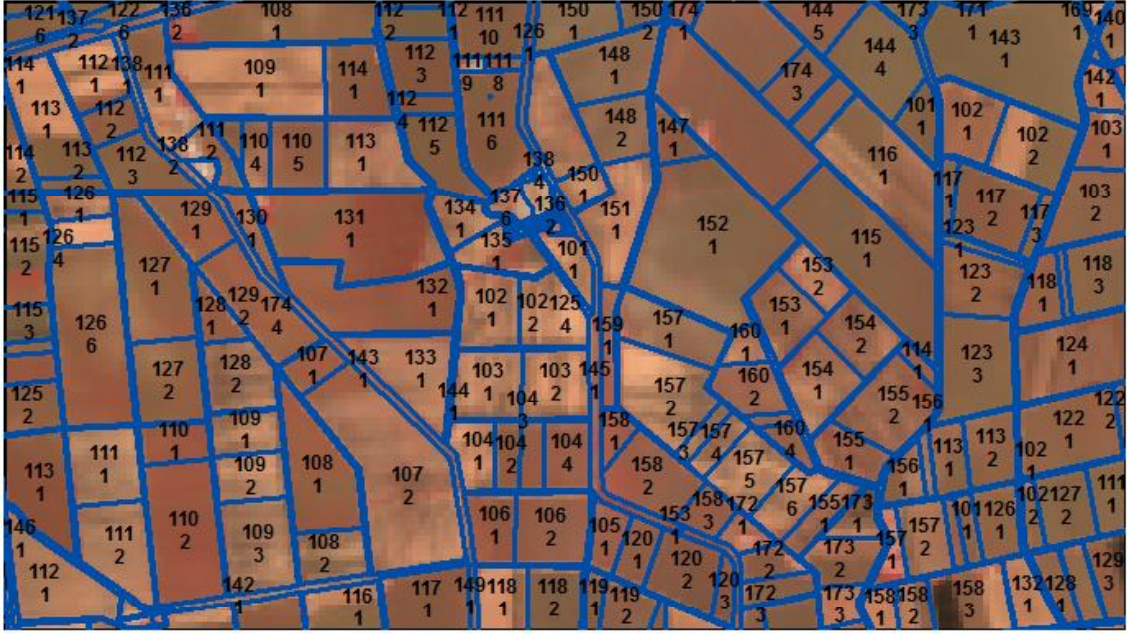
Şekil 6.19. 27/06/2013 tarihli LANDSAT-8 görüntüsü ile kadastro parsellerinin çakıştırılmış görüntüsü
