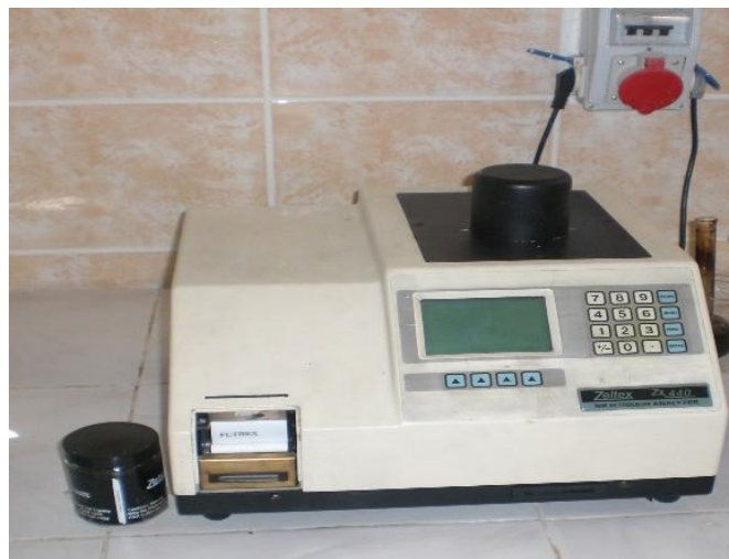
Şekil 3.15. Setan sayısı ölçüm cihazı
