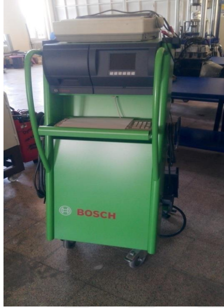
Şekil 4.7: Bosch BEA Emisyon Ölçüm Cihazı
