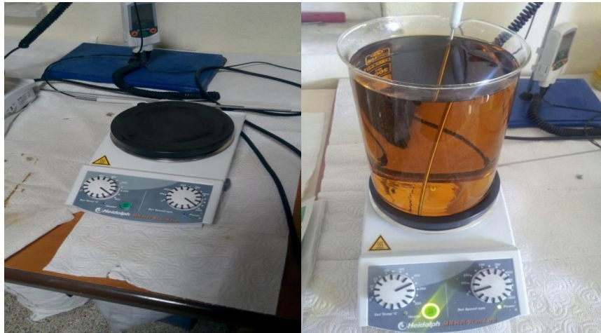
Şekil 2.5: Biyodizelden Alkolün Uzaklaştırılması İşlemi (manyetik karıştırıcı)
