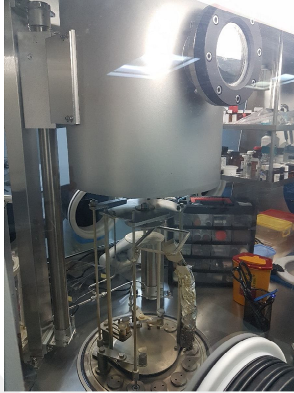
Şekil 3.4. Glovebox sistemine entegre fiziksel buhar biriktirme cihazı.
