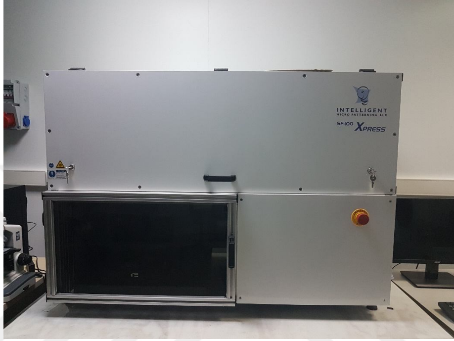
Şekil 3.6. Intelligent Micro Patterning SF-100 XPRESS maskesiz fotolitografi cihazı.
