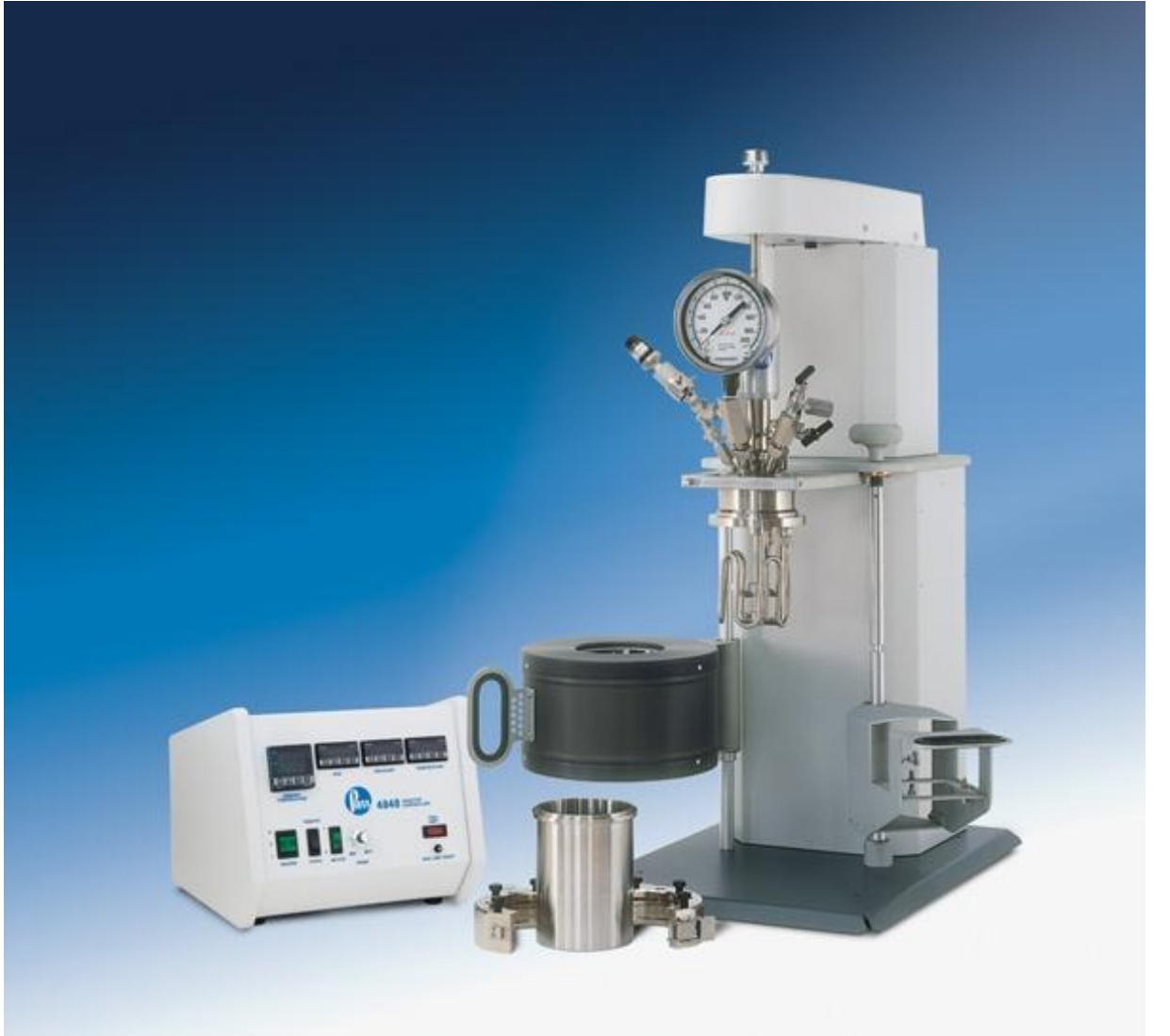
Şekil 3.2 P. sylvestris çam odununun ön işleme için kullanılan Parr reaktör sistemi
