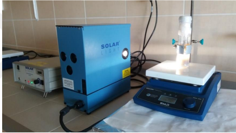
Şekil 3.2. Fotokatalitik hidrojen üretimine dair çalışma sistemi
