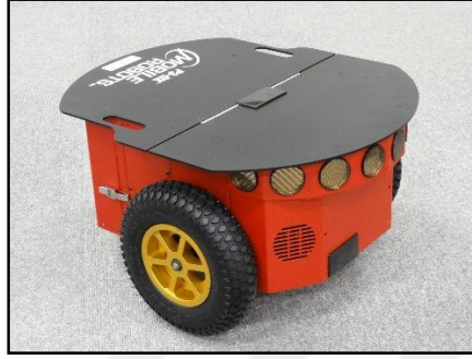
Şekil 4.1. Pioneer 3-DX robotunun genel görünüşü
