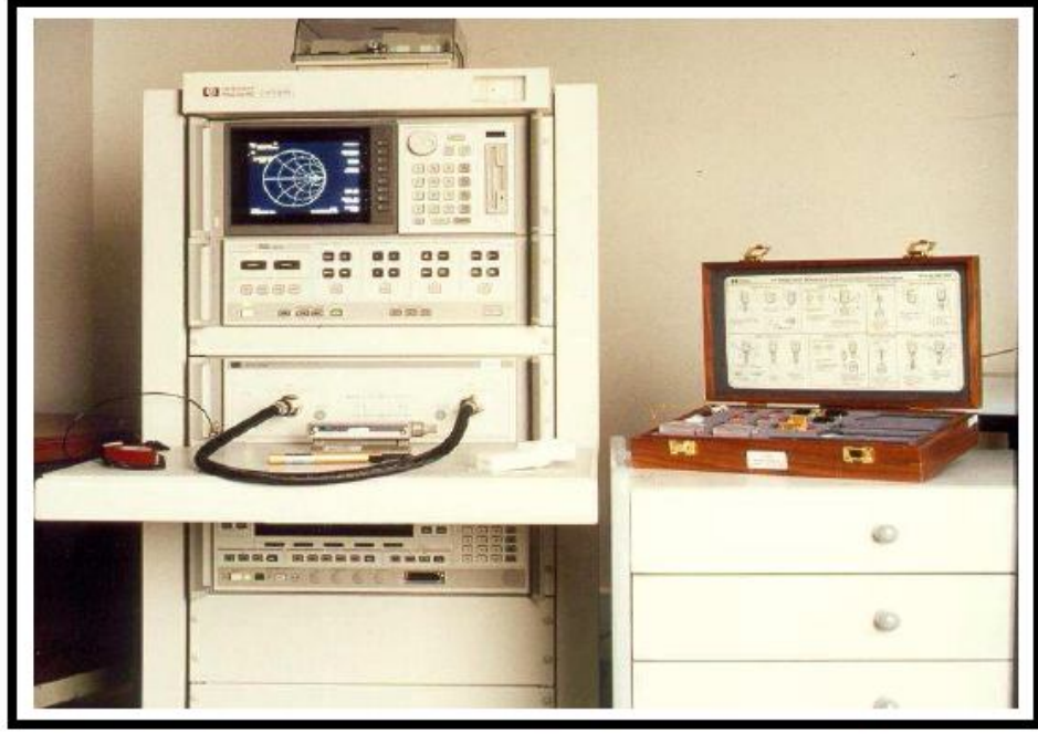
Şekil 3.5: UME Laboratuvarındaki ölçüm yapılan VNA ve Kalibrasyon Kiti
