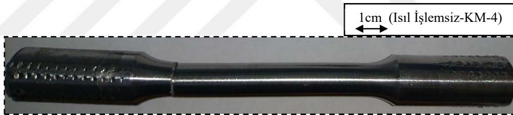
Şekil 6.67 Kaynak sonrası ısıl işlem uygulanmamış 0.8Ni-1.5Co içeren kaynak metali çekme testi numunelerine ait fotoğraf ( \sigma_{ak}:1225\text{ MPa} , \sigma_{\check{c}}:1237\text{ MPa} , % uzama: 3)
