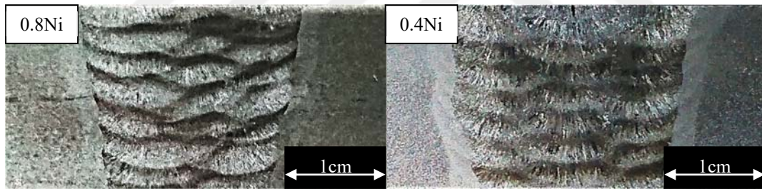
Şekil 6.5 % 0.8Ni ve 0.4Ni içeren kaynak metallerine ait makro fotoğraflar (dağlama FeCl_3 )
