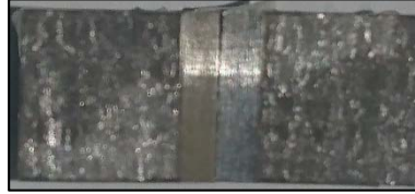
Şekil 6.54 Isıl işlem uygulanmamış 0.8Ni-1.5Co içeren kaynak metali Charpy darbe testi numunesi fotoğrafı
