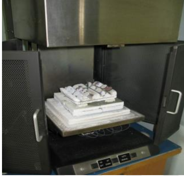
Şekil 5.35. TBC'lerin termal çevrim deneyinde fırın içinden görünümü
