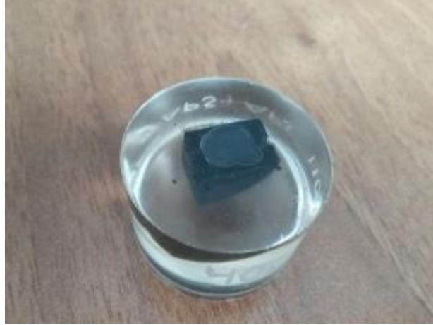
Şekil 4.5. SEM’de görüntü almadan önce hazırlık aşamasında termal çevrim ve sıcak korozyon testleri sonrası TBC’lerin soğuk bakalite alınmış hali
