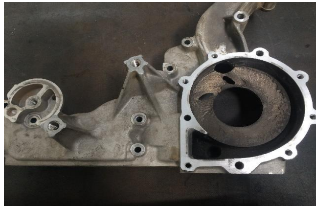
Şekil 1.22. Ağır vasıtalarda kullanılan su pompasında meydana gelen erozyon aşınması
