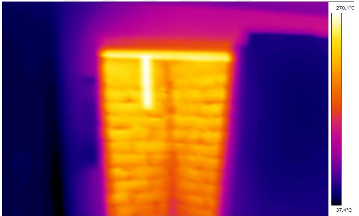
Şekil 5.15. Deney sonunda yangın söndürüldükten sonra odanın soğumaya bırakıldığı anda yangın odası iç kısmının duvar ve termacouple ısının termal görüntüleri
