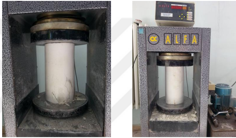
Şekil 5.16. Basınç dayanımı deneyi
