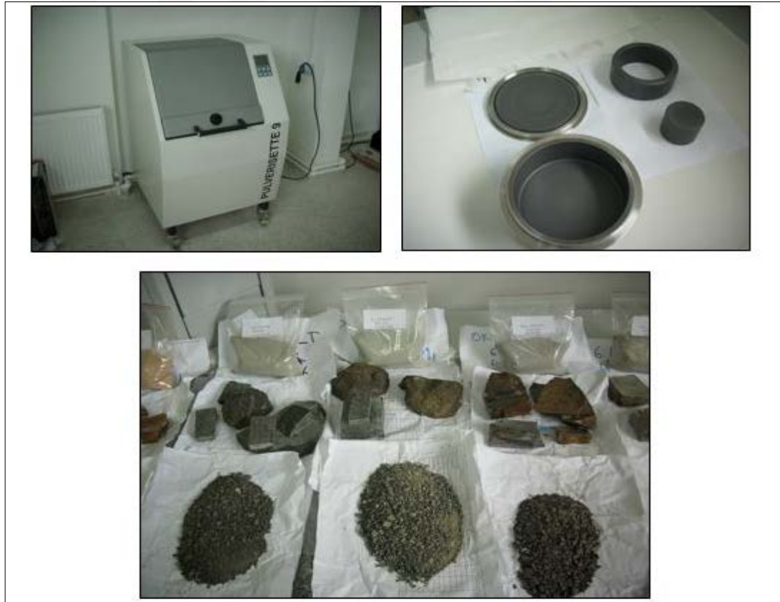
Şekil 2.1 Tungsten karbid kaplamalı titreşimli halkalı öğütücü ve numune hazırlama aşamaları
