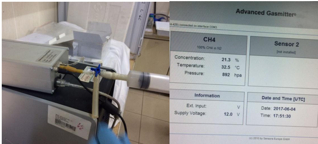
Şekil 3.9. Metan dedektöründe metan miktarı ve yüzdesinin belirlenmesi (24.saat)
