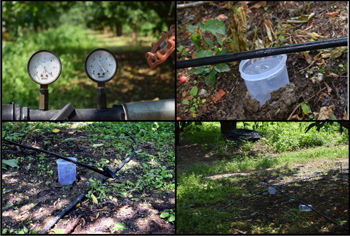
Şekil 3.3 (4 nolu) bahçede damlatıcı debi ölçümü
