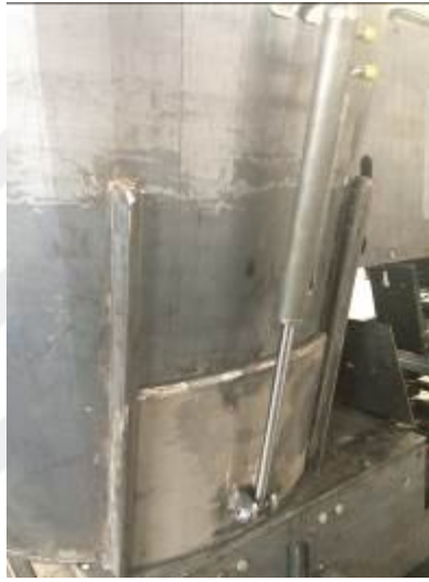
Şekil 3.7. Depodaki boşaltma kapağı ve hidrolik silindirin görünüşü
