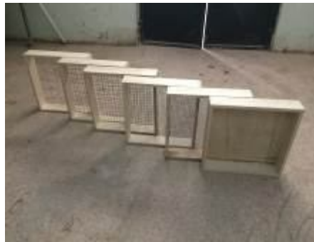
Şekil 3.13. Rasyonun elenmesinde kullanılan elek takımı
