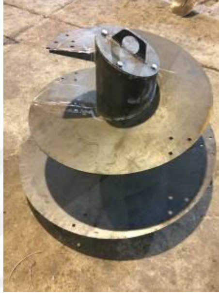
Şekil 3.6. Helezonun imalat aşaması
