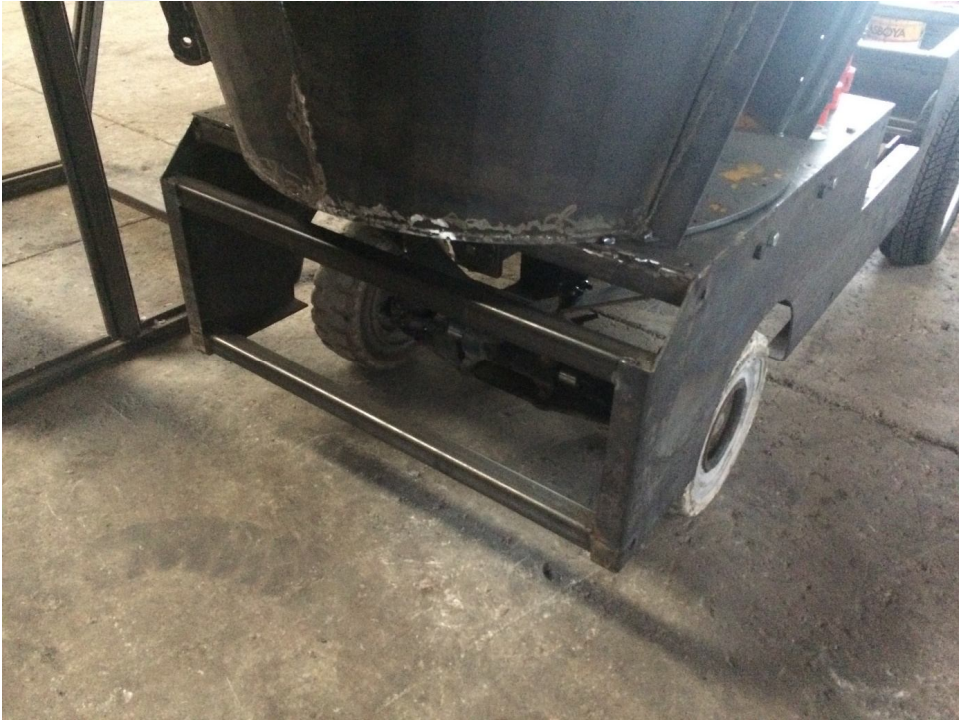
Ek Şekil 6. Depo bağlantısının görünüşü
