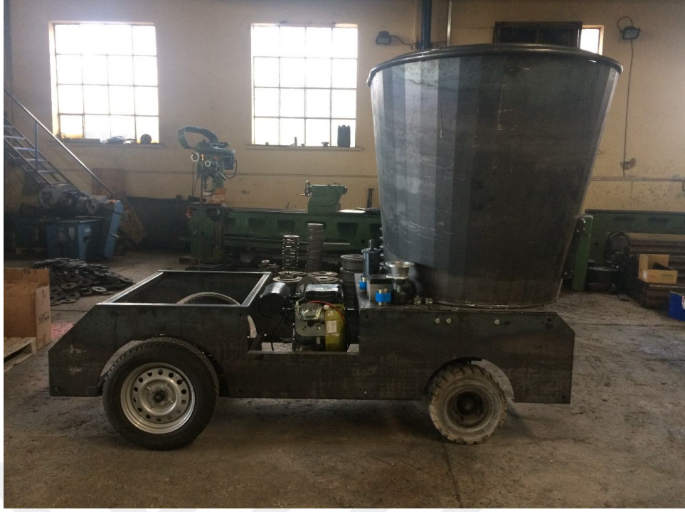
Ek Şekil 3. Motorun yerleştirilmesi
