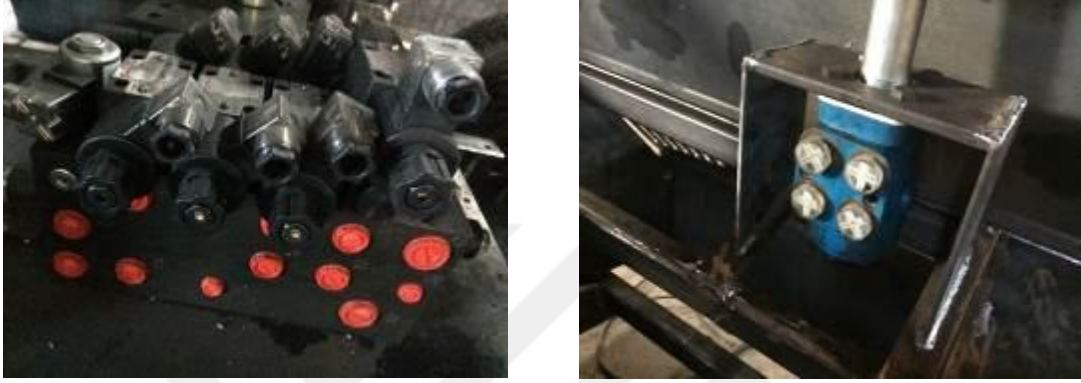
Şekil 3.8. Hidrolik valf bloğu ve direksiyon kontrol valfi
