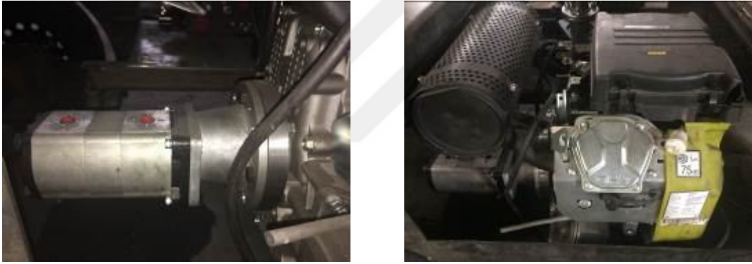
Şekil 3.1. Motor ve pompa akuplasyonu
