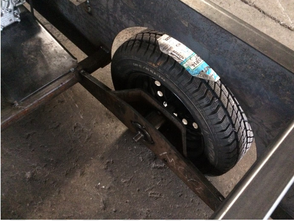
Ek Şekil 5. Şasinin ve tekerleğin bağlantısı
