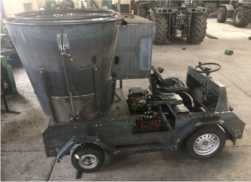
Ek Şekil 8. Hidrolik bağlantıların görünüşü
