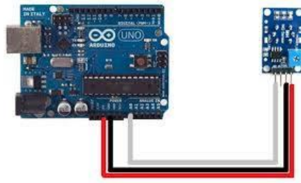
Şekil 3.18. Arduino ve sensör bağlantısı
