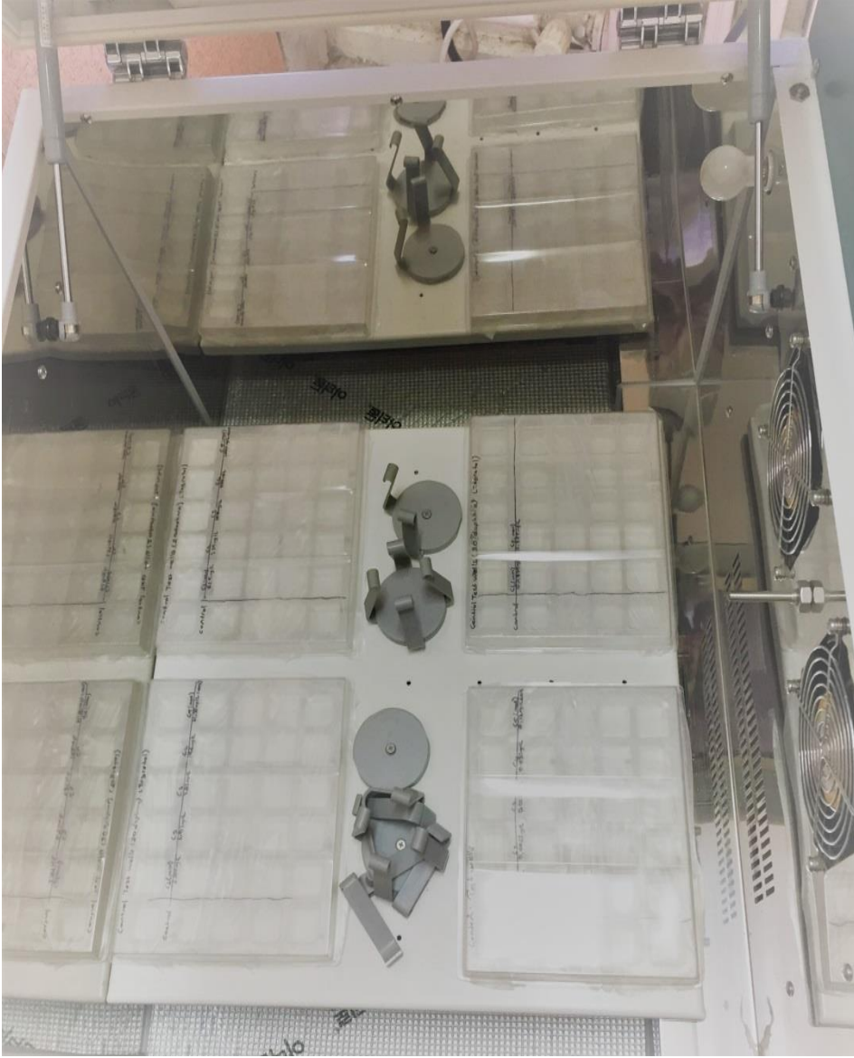
Resim 4. Hazırlanan test tabaklarının Daphnia magna toksisite testi için 24 ve 48 saat süresince inkübatörde bekletilmesi
