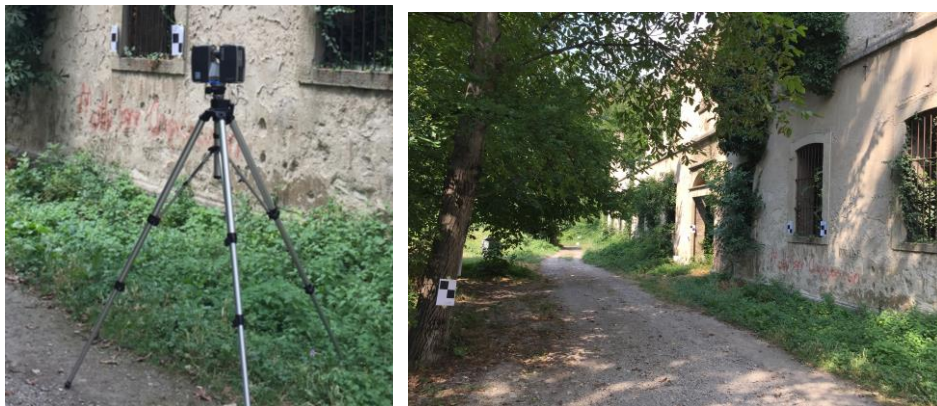
Resim 78. ve Resim 79. Lazer tarayıcı ve farklı istasyonların birleştirilmesi için kullanılan hedeflerin yerleştirilmesi
