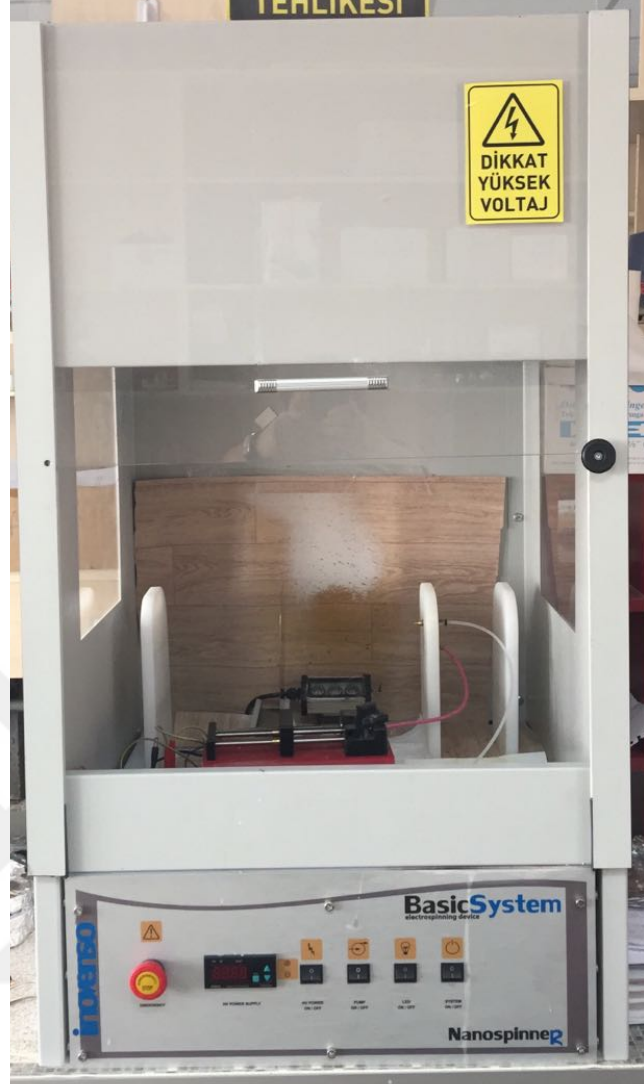
Şekil 3.7. Fiber üretmek için kullanılan elektroğirme cihazı
