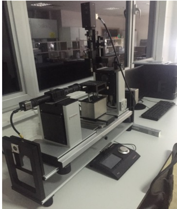
Şekil 3.10. Çalışmalarda kullanılan temas açısı ölçüm cihazı
