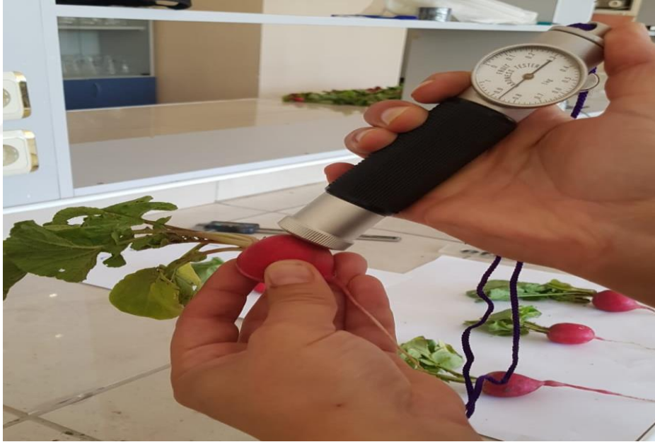
Resim 4.7. Hasat edilen turpların penetrometre yardımı ile sertliklerinin ölçülmesi
