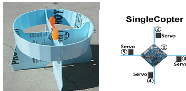
Şekil 8. Tek motorlu iha (Singlecopter)(Kaymak ve Çöl, 2013).
