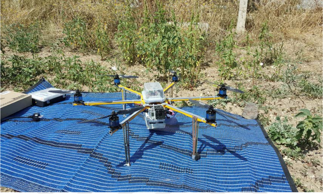
Şekil 28. Çalışmada kullanılan altı motorlu insansız hava aracı
