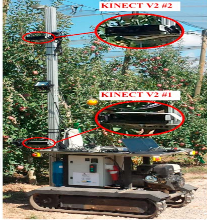
Şekil 22. Kinect v2 sensörleri kullanılarak yapılan meyve toplama aracının görünümü (Gené-Mola ve ark., 2019).
