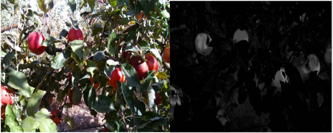
Şekil 42. Kırmızı elmaların rgb formatındaki görüntüden ayrıştırılması işlemi.
