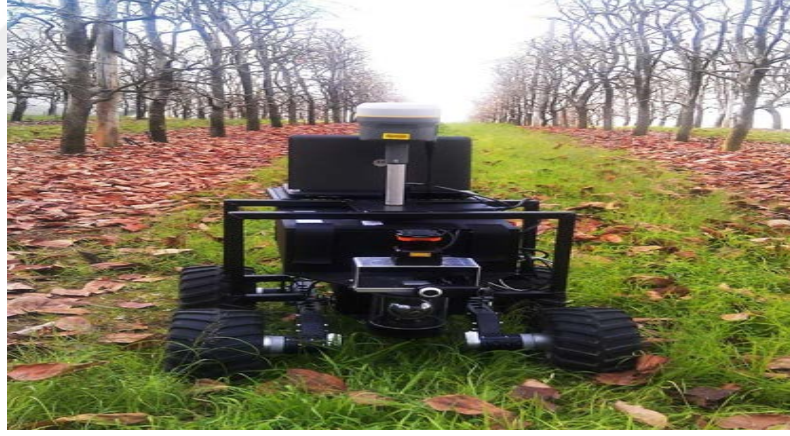
Şekil 17. Alan taraması için kullanılan robot ve görüntü alma sistemi(Shalal ve ark., 2015).
