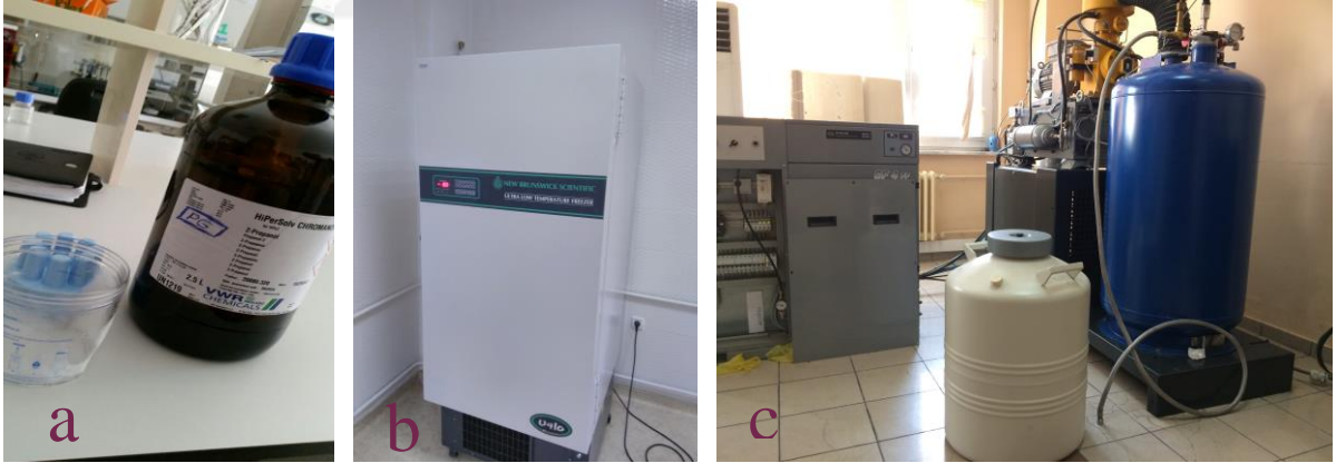
Şekil 3.12. Hücre dondurma cihazları; (a) izopropil ile dolu delikli vial kabı, (b) -80\text{ }^{\circ}\text{C} dondurucu dolap (c) -196\text{ }^{\circ}\text{C} sıvı azot tankı
