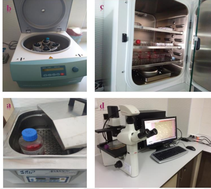
Şekil 3.4. MCF-7 ve L929 hücrelerinin subkültüründe kullanılan cihazlar; (a) su banyosu, (b) santrifüj, (c) inkübatör (d) invert mikroskop
