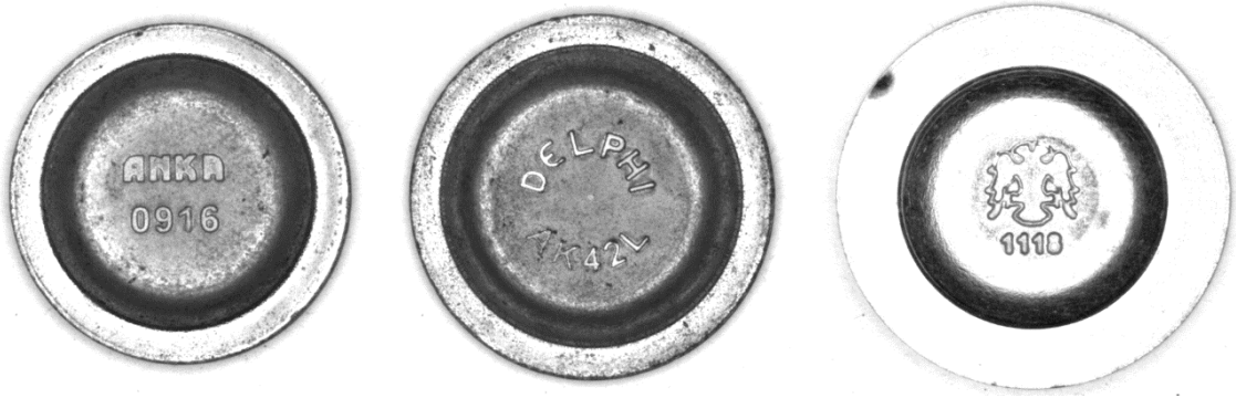
Şekil 3.3. Dom ışık kaynağı kullanılarak pozlama süresi 8ms olan kamera görsel sonuçları
