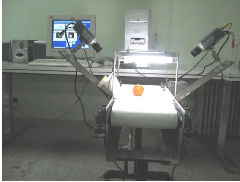
Şekil 2.7. Narenciye sınıflandırma sistemi (Omid ve ark., 2010).
